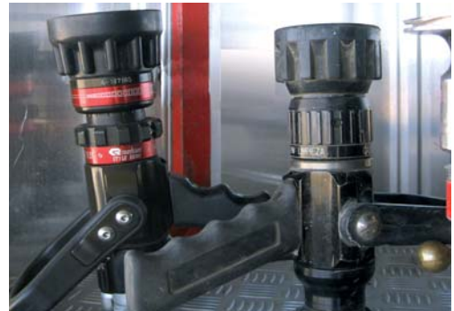
Figura nº 7 Lanzas con regulación de caudal
