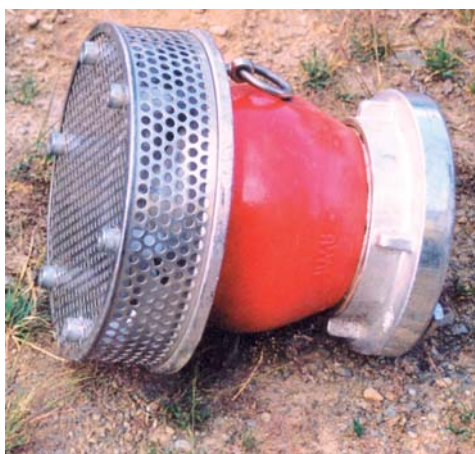
Figura nº 54 Detalle de alcachofa anti-retroceso
