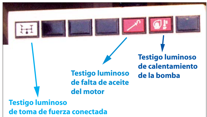
Figura n° 49 Testigos luminosos en la bomba
