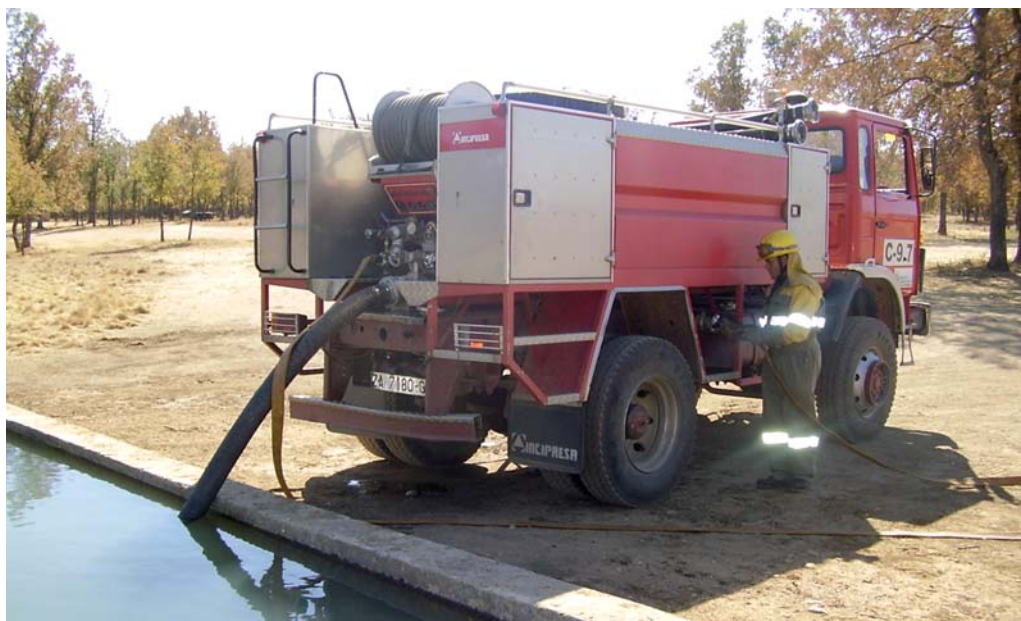
Figura nº 46 Operario cargando con un "puente"
