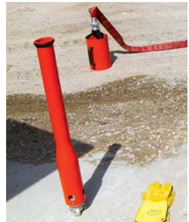
Figura nº 14 Lanzas con dispositivo generador
