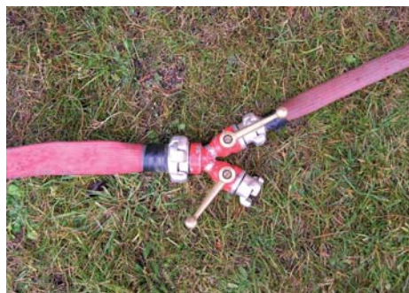
Figura nº 24 Tendido con bifurcación \varnothing 45 a \varnothing 25
