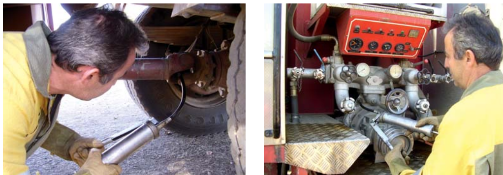
Figura nº 55 y 56 Conductor engrasando toma de fuerza y bomba
