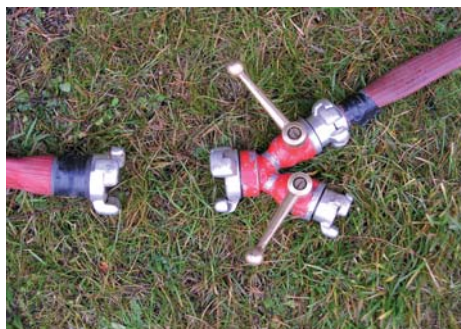
Figura nº 25 Tendido cerrado al irse la autobomba
