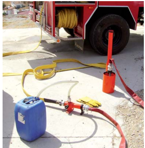
Figura nº 18 Inyector a la salida de bomba y lanza con generador
