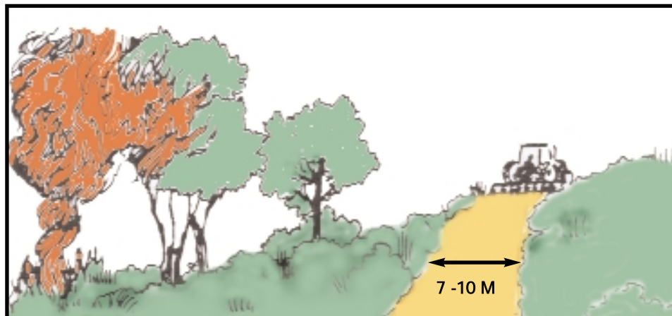
Apertura de franja en fuego de copas con maquinaria pesada
