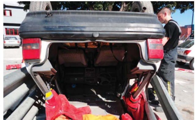
Víctima y Sanitario protegidos con protección blanda. Detalle del espacio creado. Abordaje frontal a la víctima. Trabajo conjunto Sanitario-Bombero de interior.
