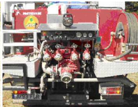
Bomba y carrete de pronto socorro.
