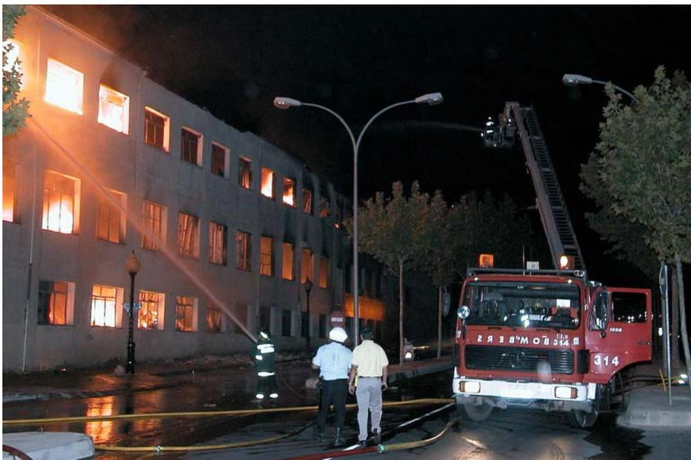
Utilización de líneas de mangueras y autobrazo de forma simultánea para control del incendio.
