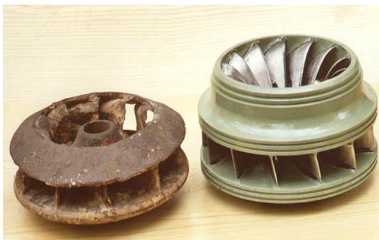
Cuando una burbuja llega a una zona de presión de la bomba, el gas retorna a estado líquido repentinamente produciendo desgaste e incluso daños importantes en la bomba. Las burbujas que colapsan en una impulsión repentina, hace que el agua impacte violentamente, como golpes pequeños y muy repetitivos, contra la superficie de trabajo de la bomba. La cavitación produce y genera un
