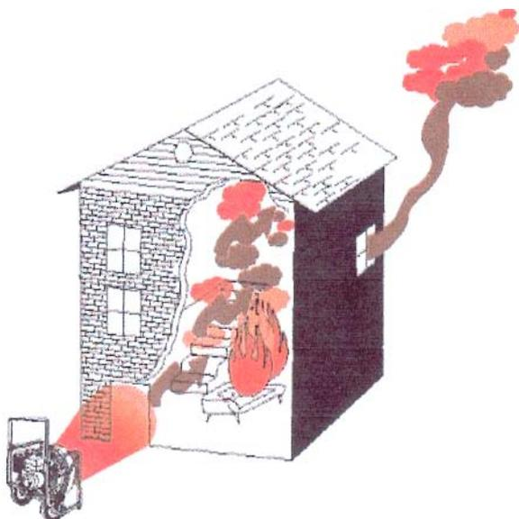
Los efectos de la ventilación forzada o mecánica son superiores a los de la ventilación natural, permitiendo un mayor control del movimiento de los humos. Podemos dirigir el movimiento de los humos a través del edificio superando los efectos que la humedad, viento y temperatura tienen sobre la ventilación natural.
