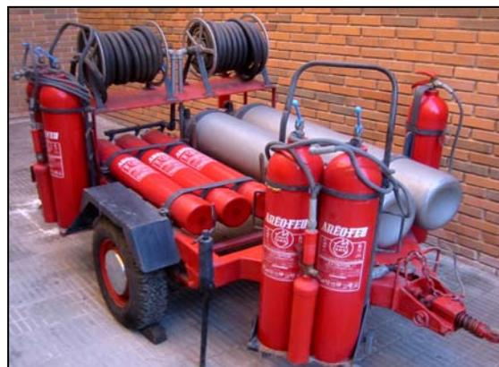
Fig. 23- Carro de extintores de CO<sub>2</sub>
