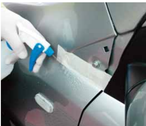
► Se humedece la zona afectada
