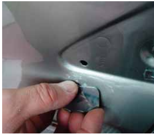
► Eliminación del descolgado del barniz con cuchilla
