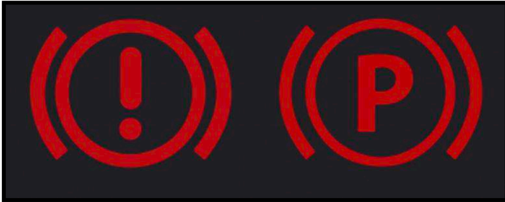
Figura 19. Testigos de frenos de parqueo.
