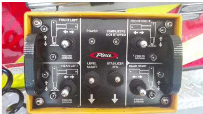
Figura 7. Control Remoto de Estabilización.
