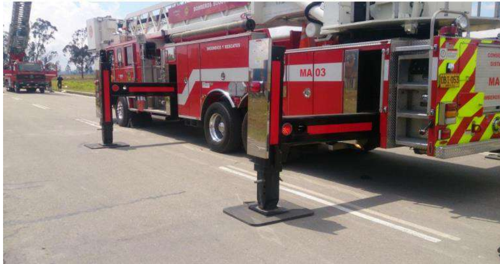
Figura 4. Estabilización segura de vehículo.
