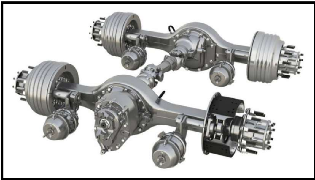
Figura 8. Eje tándem o doble troque.
