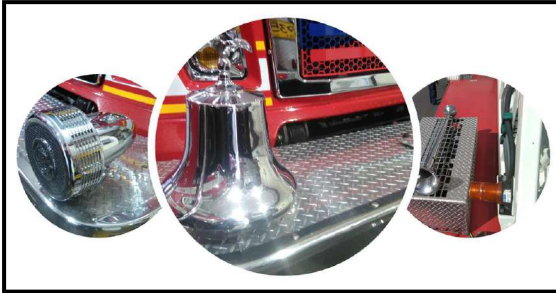
Figura 12. Sistemas de advertencia acústica de un vehículo de emergencia.
