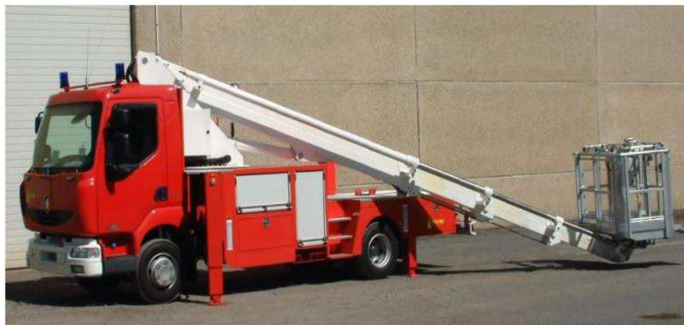
Figura 15. Sistema telescópico con tubería montante.
