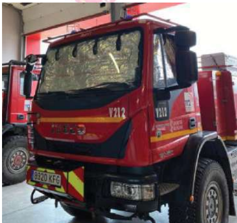
Ilustración 7, 8 y 9. Cortinas ignífugas equipadas en las autobombas. Detalle del plegado y desplegado. Fuente: Vallfirest.
