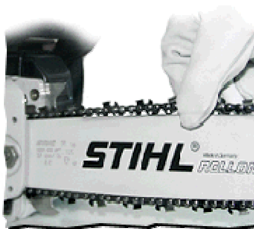
Tensión correcta de la cadena en frío
