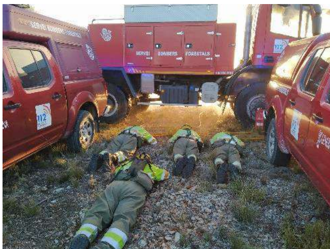
Ilustración 34, 35 y 36. Ubicación de vehículos ligeros perpendiculares a la autobomba. Creación de zona de refugio. Fuente: SBF.
