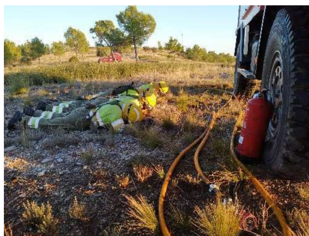
Ilustración 28, 29, 30 y 31. Ubicación perpendicular al avance del fuego. Dinámica de fluidos al atravesar el aire convectivo la estructura del bastidor de la autobomba. Fuente: SBF
