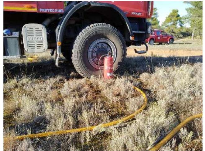
Ilustración 26 y 27. Ubicación extintor. De forma normal hacer coincidir su ubicación al de lanza de seguridad Fuente: SBF.
