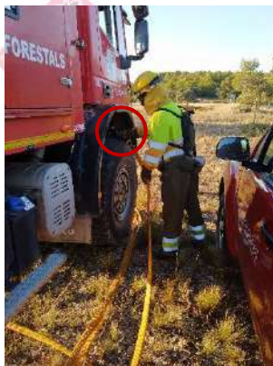
Ilustración 15 y 16. Ubicación de lanza de seguridad, parte cercana a la cabina. Detalle del despliegue de tendido de lanza acortinadora y lanza de seguridad. Fuente: SBF.
