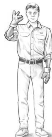
Indica que se enrolle el cabestrante en arranques cortos y rápidos.
