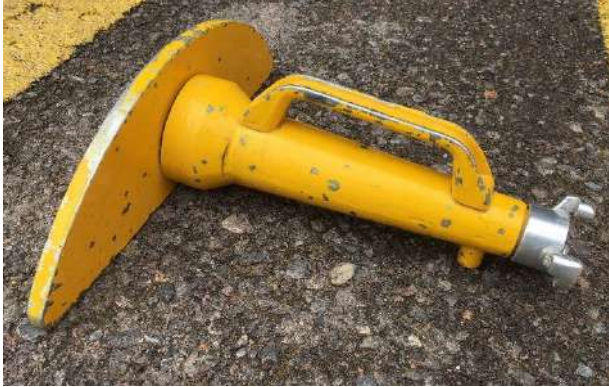
Ilustración 13 y 14. Lanza de autoprotección con salida de 25 mm de diámetro y detalle de la salida de agua con abrazadera e impurezas acumuladas en la misma. Fuente: SBF.
