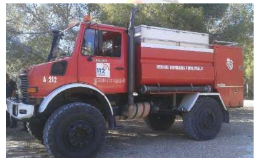
Ilustración 11. Autobomba sin sistema de autoprotección. Fuente: SBF.
