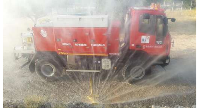
Ilustración 6. Detalle cortina de agua. Fuente: SBF.
