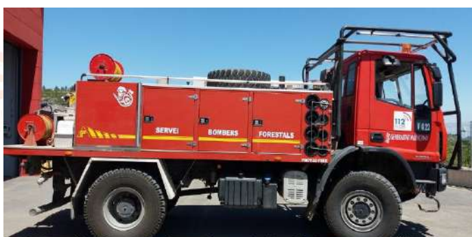
Ilustración 82. Autobombas con sistemas de autoprotección. Fuente: SBF.
