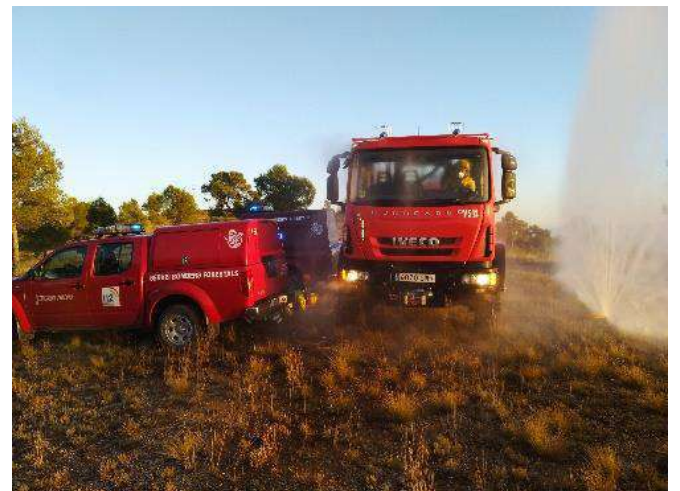
Ilustración 34, 35 y 36. Ubicación de vehículos ligeros perpendiculares a la autobomba. Creación de zona de refugio. Fuente: SBF.
