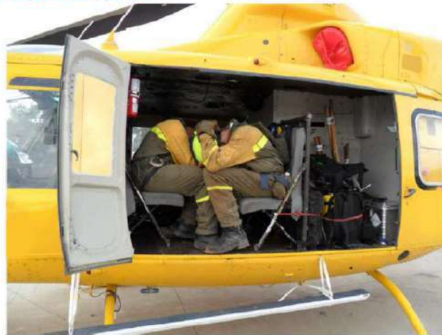
(B-212/412) Asientos desmontables, atalajes de 2 puntos y sin reposacabezas.
