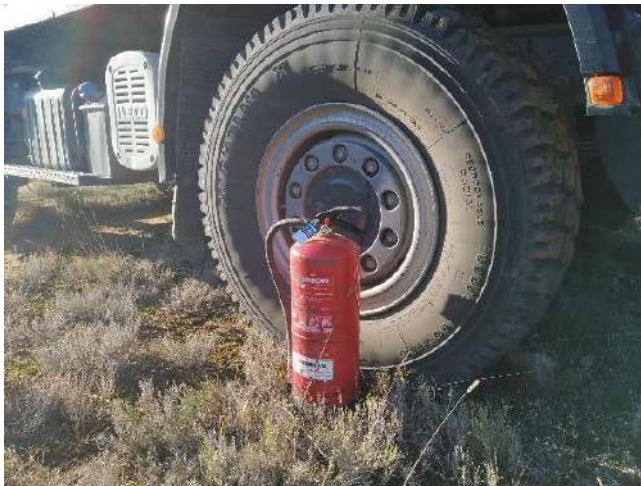
Ilustración 26 y 27. Ubicación extintor. De forma normal hacer coincidir su ubicación al de lanza de seguridad Fuente: SBF.
