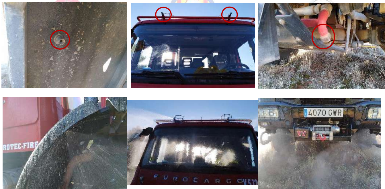
Ilustración 20 a 25. Distintas ubicaciones y difusores (ruedas, cabina y frontal) del sistema de autoprotección. Fuente: SBF.
