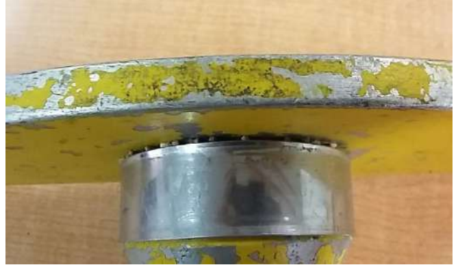
Ilustración 13 y 14. Lanza de autoprotección con salida de 25 mm de diámetro y detalle de la salida de agua con abrazadera e impurezas acumuladas en la misma. Fuente: SBF.
