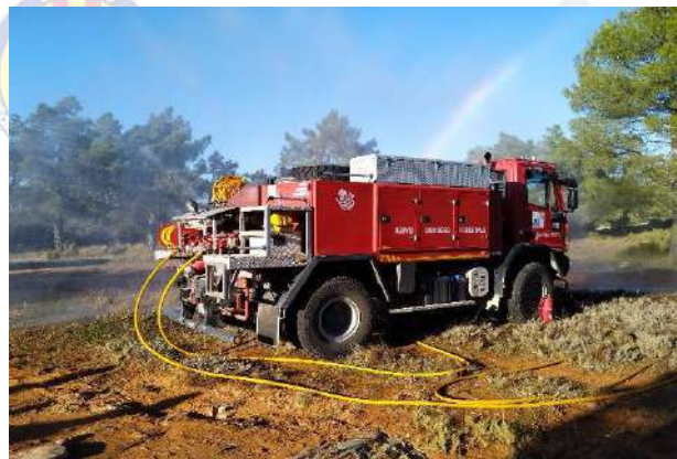
Ilustración 15 y 16. Ubicación de lanza de seguridad, parte cercana a la cabina. Detalle del despliegue de tendido de lanza acortinadora y lanza de seguridad. Fuente: SBF.
