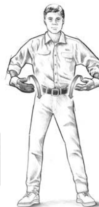
Asistencia en la conducción, indicar al conductor que dé más potencia a las ruedas para ayudar en el proceso de tracción con el cabestrante.
