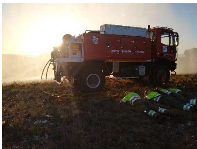
Ilustración 28, 29, 30 y 31. Ubicación perpendicular al avance del fuego. Dinámica de fluidos al atravesar el aire convectivo la estructura del bastidor de la autobomba. Fuente: SBF
