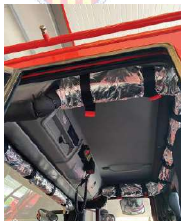
Ilustración 7, 8 y 9. Cortinas ignífugas equipadas en las autobombas. Detalle del plegado y desplegado. Fuente: Vallfirest.
