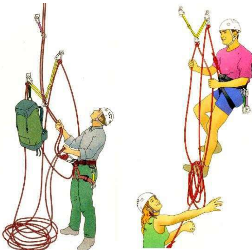
Fig. 68. Técnica de escalada. Sistemas de seguro, a la izquierda asegurando al puntero o guía; a la derecha seguro del segundo. Se destaca el uso del nudo dinámico en los sistema de aseguramiento (Pézl, 1999).
