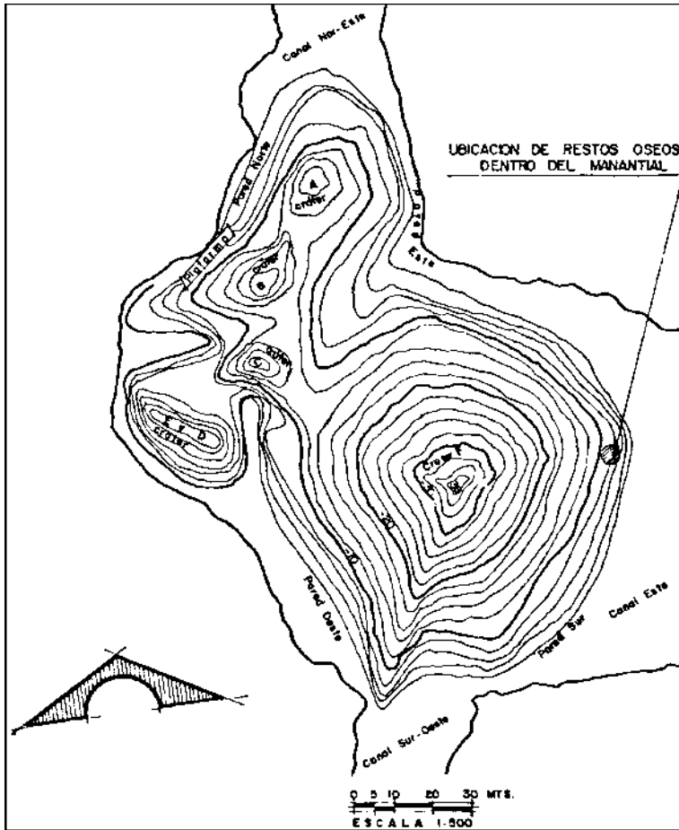
Fig. 40. Batimetría de La Laguna de la Media Luna, INAH, 1983. Equidistancia entre las curvas de dos metros.
