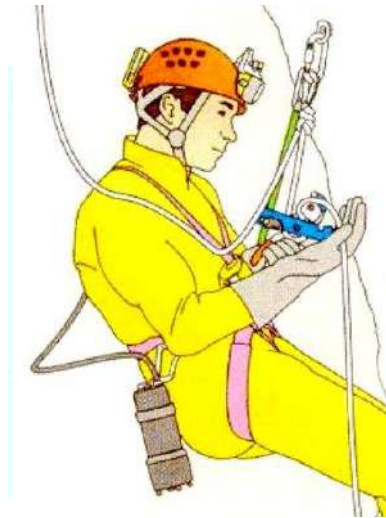
Fig. 78. Paso de un fraccionamiento durante el descenso (Patzl, 1999).
