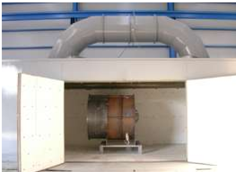
Figura 2: Ensayo a alta temperatura de ventiladores para túneles en TST
