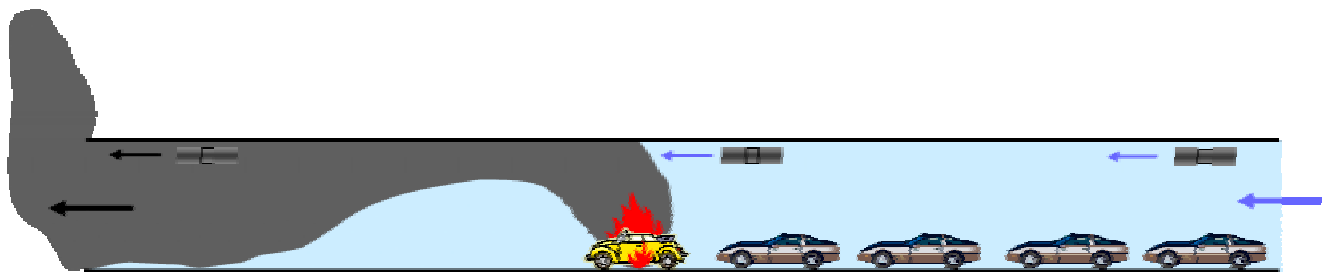
Figura 6: Evolución de los humos con ventilación longitudinal
