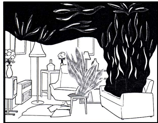
Imagen 8: Los gases de pirólisis comienzan a arder.
