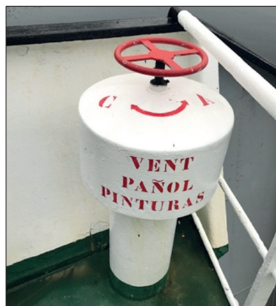
Telemando de las válvulas de mariposa contra incendios y parada de la ventilación (Izq). Cierre de la ventilación del pañol de pintura (Dcha).
