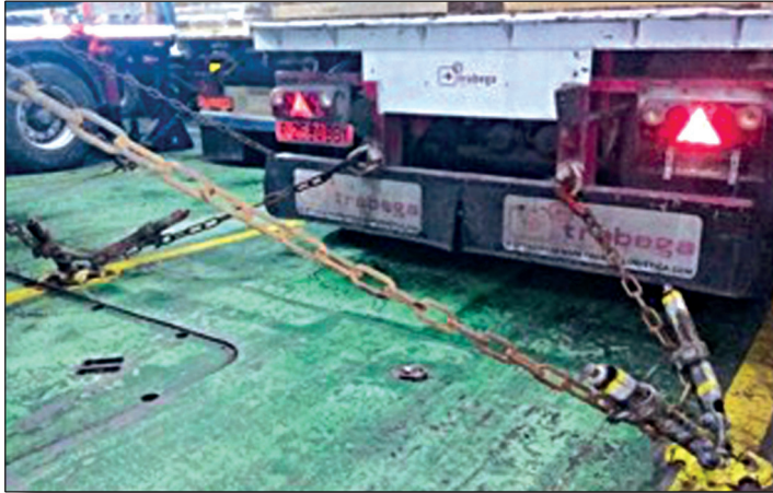
Trincaje de vehículos en la bodega de carga de un buque Ro-Ro.
