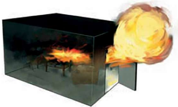
El área pre-mezclada se inflama. Lo cual ocurre en la zona oscura del interior.
