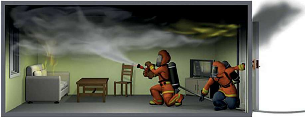
Enfriamiento de los gases de incendio
