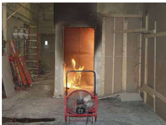
Puerta de acceso con ventilación natural.
