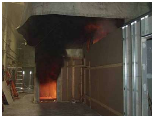
Efecto del VPP sobre los gases de la puerta de acceso.
