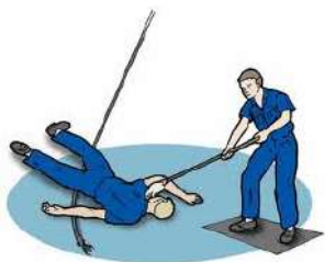
Fig. 10. Rescate en accidente eléctrico.
