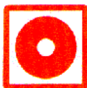
pulsador de alarma
