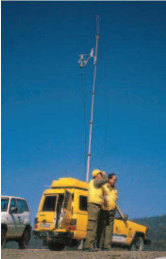
UMMT CON LAS ANTENAS Y LOS SENSORES DE METEOROLOGÍA DESPLEGADOS.
