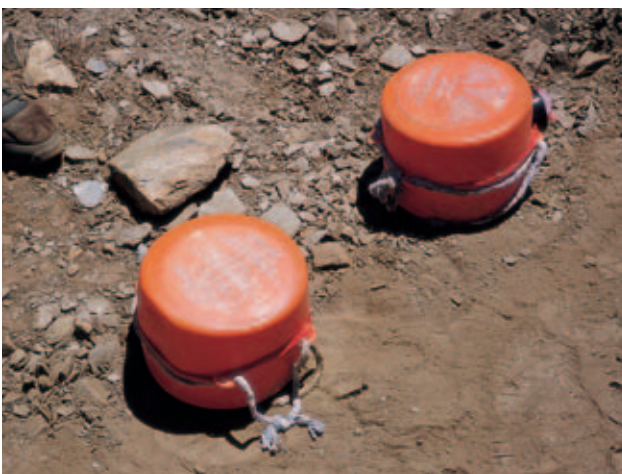
EXTINTORES DE EXPLOSIÓN.
