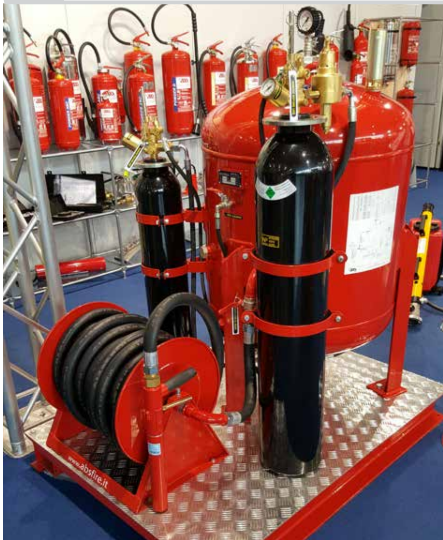
En la fotografía se puede visualizar el depósito rojo de polvo químico seco, los tanques negros que son el nitrógeno bajo alta presión que sirve como medio impulsor y la manguera de aplicación.
