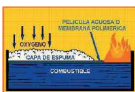
Efecto extintor de la espuma. (Imagen cedida por MPI Sistemas Contra Incendios).
