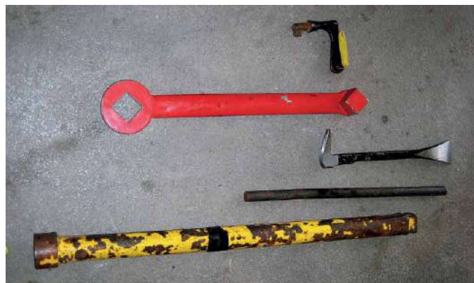
Llaves de hidrantes.
