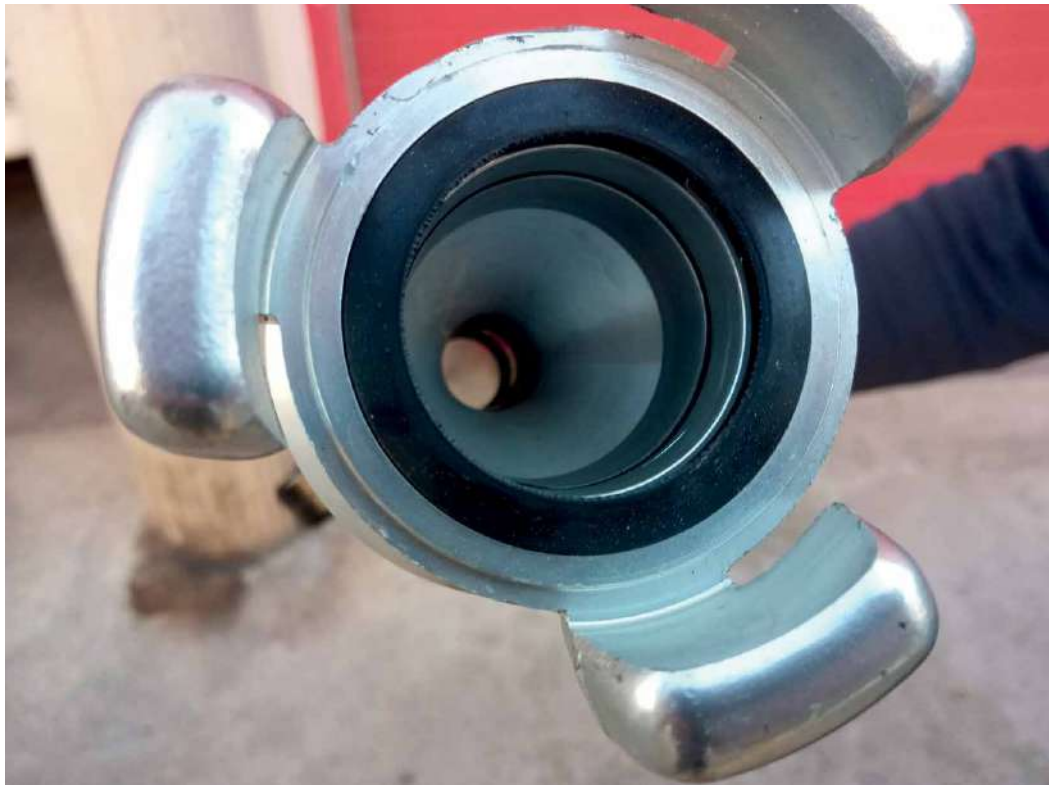
Vista del estrechamiento del premezclador.
