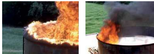
Secuencia extinción espuma. (Imágenes cedidas por MPI Sistemas Contra Incendios).
