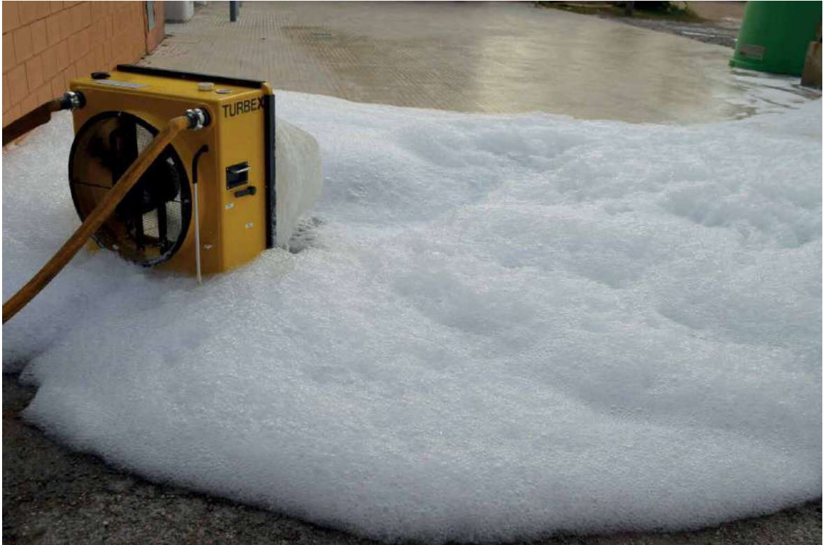
Inundación mediante espuma de alta expansión.
