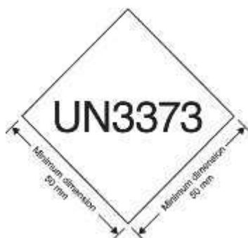
Fig. 7.1 Ejemplo del formato del número UN que debe emplearse para las sustancias infecciosas de categoría B.
