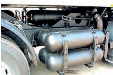
Depósitos GNC en un camión
