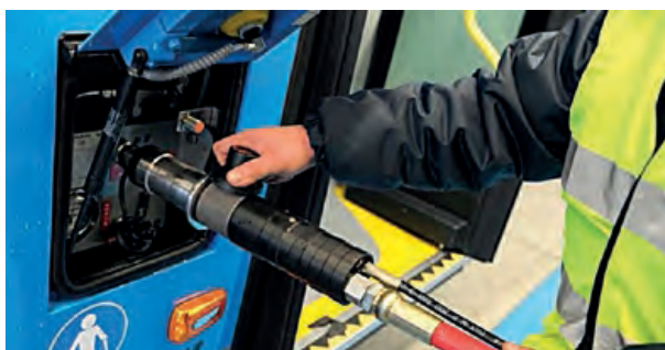
Boca de llenado GNC en un autobús
