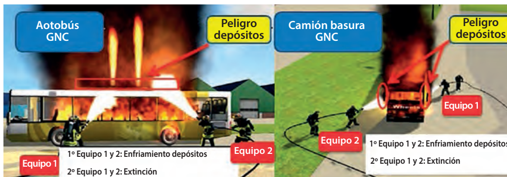
Caso 2 ejemplo: Incendio en vehículos pesados a gas
