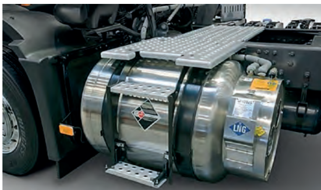
Depósito GNL en un camión Dual-Fuel
