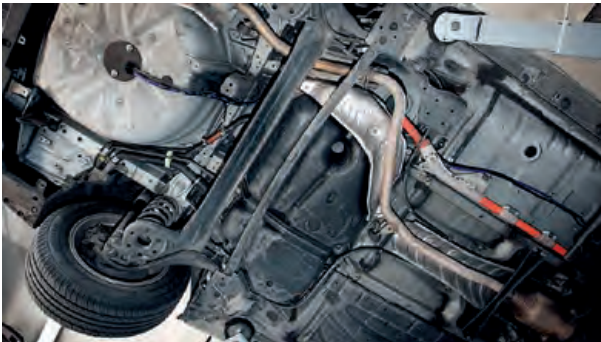
Tubería de GLP en un turismo híbrido convertido
