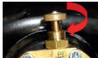
Llave de cierre depósito de GLP
