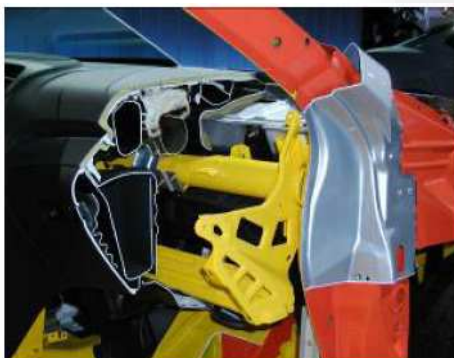
Refuerzos de Acero microaleado tratado con Borón en tablero y puertas (color amarillo)
