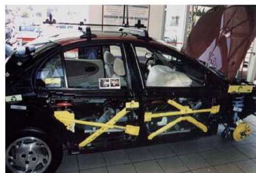
Refuerzos de Acero microaleado tratado con Borón en tablero y puertas (color amarillo)
