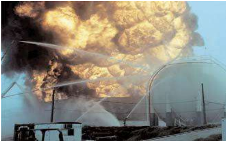
Refrigeración esfera GLP cercana a tanque incendiado
