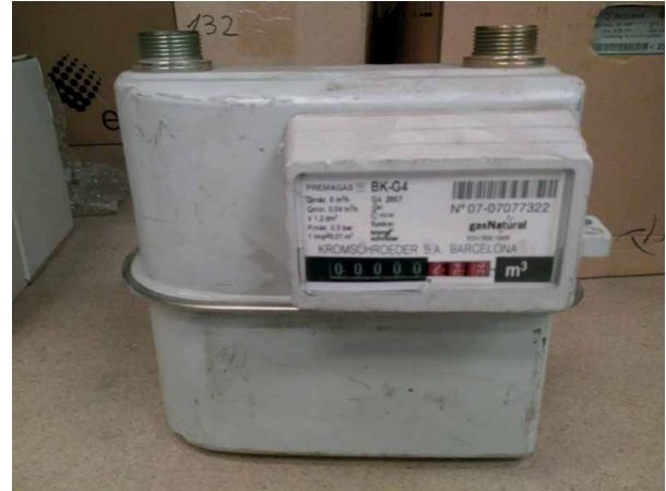
Contador de gas.
