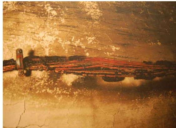
Fotografías 6.8 y 6.9 - Detalles de dos instalaciones eléctricas atacadas por el fuego desde el exterior (obsérvense los restos calcinados de los revestimientos de los conductores, los cuales quedaron adheridos tras su enfriamiento y que descartan la posibilidad de que el origen del fuego fuese interno).
