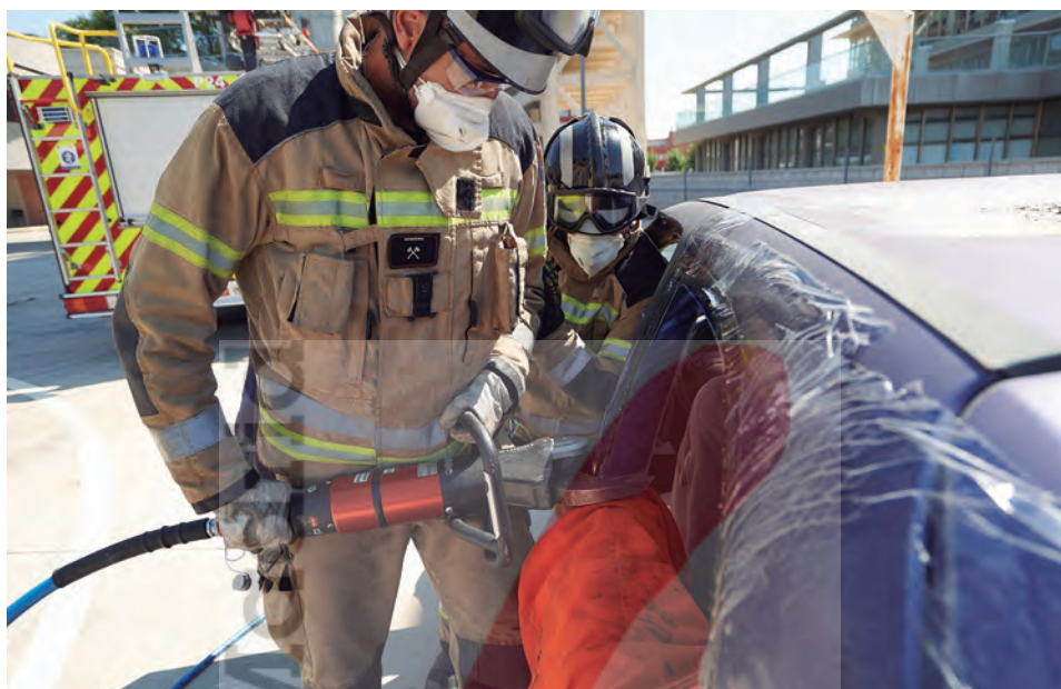
Imagen 17. Corte con cizalla del montante B
