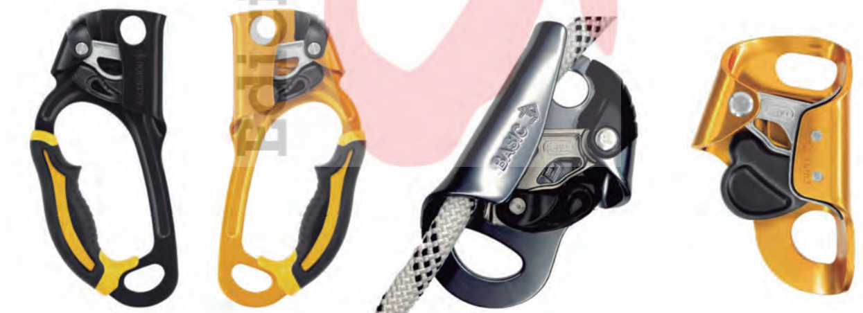
Imagen 36. Diferentes modelos de bloqueadores. De izquierda a derecha: Ascension, de Petzl, versión mano derecha e izquierda, empleado para el ascenso por cuerda mediante pedal y también como polifreno. Basic, de Petzl, en esencia similar al anterior, pero sin asa de agarre, específico para frenos en polipastos. Croll, de Petzl, usado como bloqueador de pecho en ascenso por cuerda.
