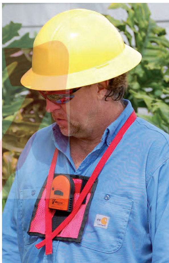
Imagen 12. Detector personal de tensión V-Watch
