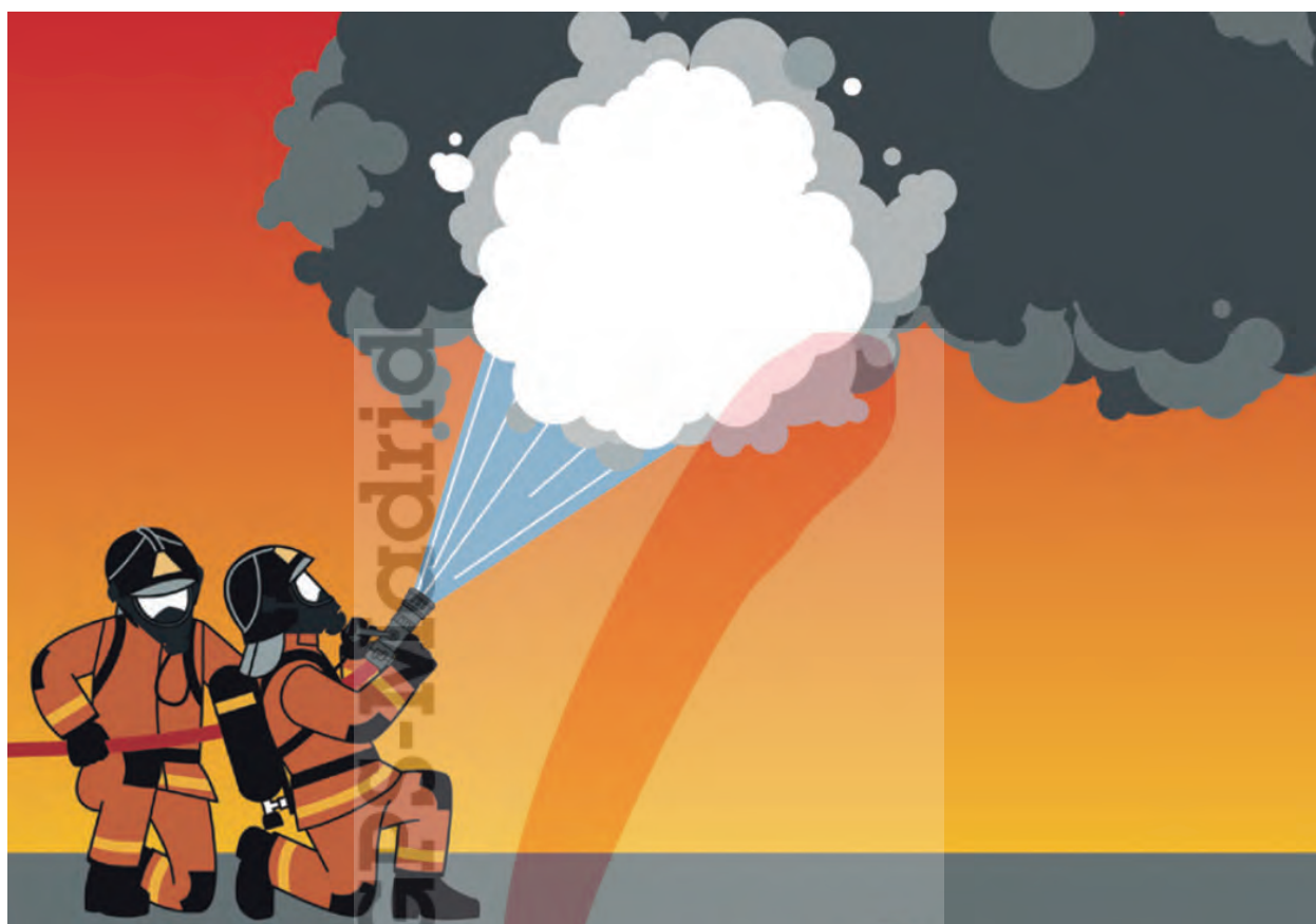
Imagen 14. Enfriamiento de gases efectuando pulsaciones de agua sobre el colchón
