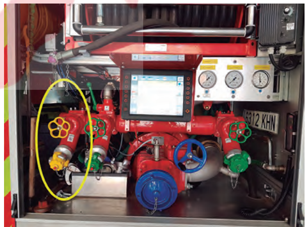
Imagen 31. Dosificador con inyección en el cuerpo de la bomba (arriba) y sistema automático con inyección en salida específica.
