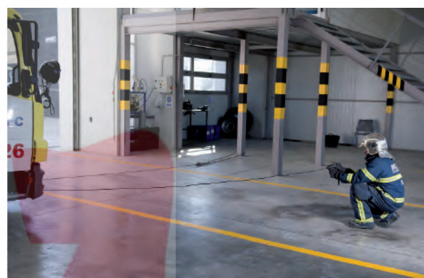
Imagen 24. Manejo seguro del cabrestante. Desde la cabina del vehículo, o a la máxima distancia del cable de arrastre.
