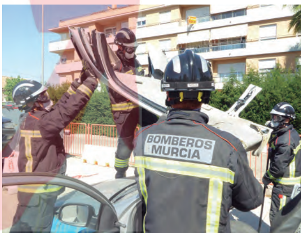
Imagen 19. Secuencia maniobra de abatimiento total de techo.
