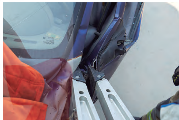
Imagen 14. Detalle puntas separador encima de bisagra
