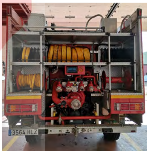
Imagen 5. Autobomba rural pesada. Visión general y puesto de bomba
