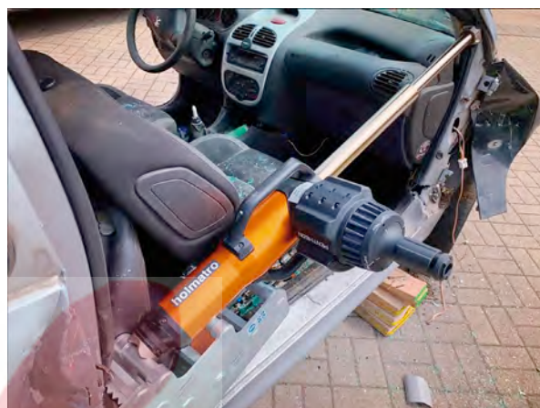
Imagen 20. Vehículo con cilindro extendido y soporte al pilar B.
