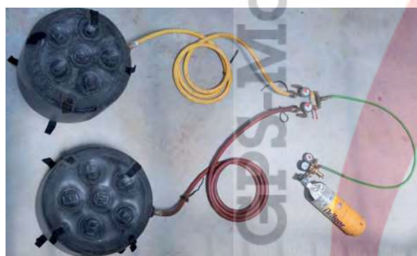
Imagen 8. Equipo de cojines de alta presión (arriba) y baja presión (abajo)
