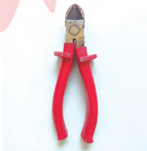
Imagen 44. Herramientas dieléctricas o aisladas: destornilladores, cortacables y alicate de corte inclinado
