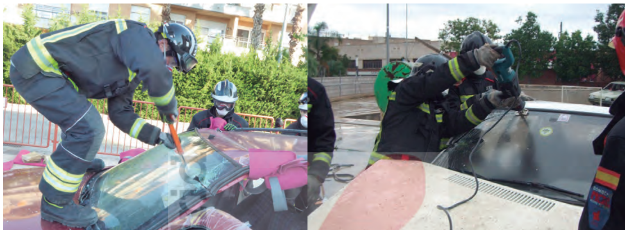
Imagen 6. Secuencia retirada de cristal laminado. Detalle del hueco del cristal y corte con sierra manual y sierra de sable
