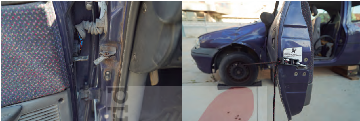
Imagen 10. Tirante de puerta cortado y apertura con sujeción mediante polea a la llanta delantera.
