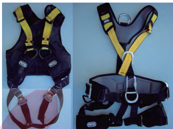
Imagen 32. Arnéses integrales para rescates en espacios confinados. Izquierda: Newton Fast Jack 2. Derecha: Navaho Complet. Ambos de la casa Petzl.
