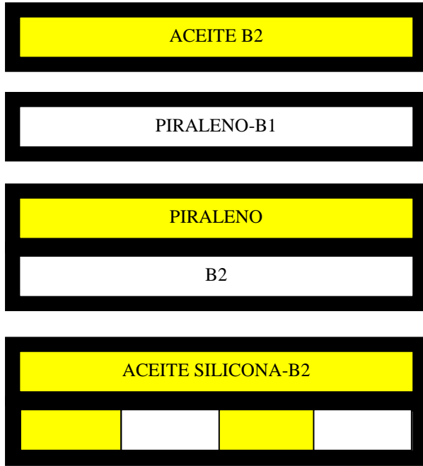
Fig.14: Distintivos de los transformadores.
