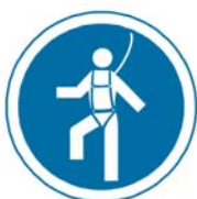
Uso de arnés de seguridad
