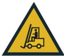
Paso de carretillas
