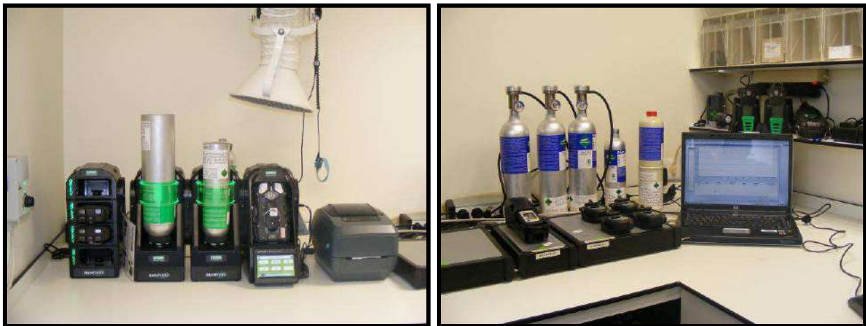
Calibración de detectores con gases patrón
