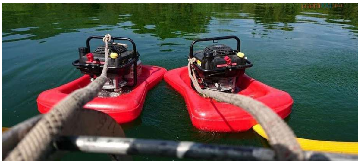
Imagen 74. Fuente de Agua No Convencional para operaciones terrestres. Bombas flotantes para suministro constante a autobombas. Estas operaciones permiten sostener durante mayor tiempo las maniobras en IUF sin necesidad de recargar el vehículo. Fuente: Heriberto, J. 2016.
