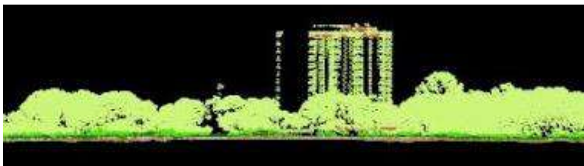
Imagen 91. Escenario LiDAR de alta definición generado para análisis de evolución y áreas de contacto con edificaciones de incendios forestales en zona de IUF. (Fuente: Medi XXI GSA).
