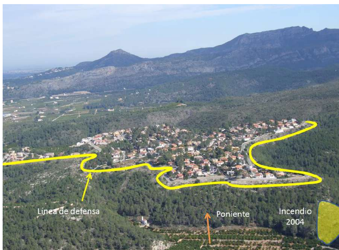
Imagen 31. Zona compacta de Interfaz Urbano Forestal. Núcleo perfectamente definido con un vial perimetral de 6 metros que permite desarrollar operaciones de defensa del perímetro. Fuente: Dalmau, F., 2007. Plan de Autoprotección de la urbanización San Blas (Carcaixent, Valencia). Medi XXI GSA.
