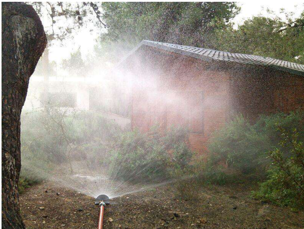
Imagen 103. Acortinador autoprotección Vallfirest conectado a línea de 25mm. Maniobra de autoprotección. Fuente: Medi XXI GSA.
