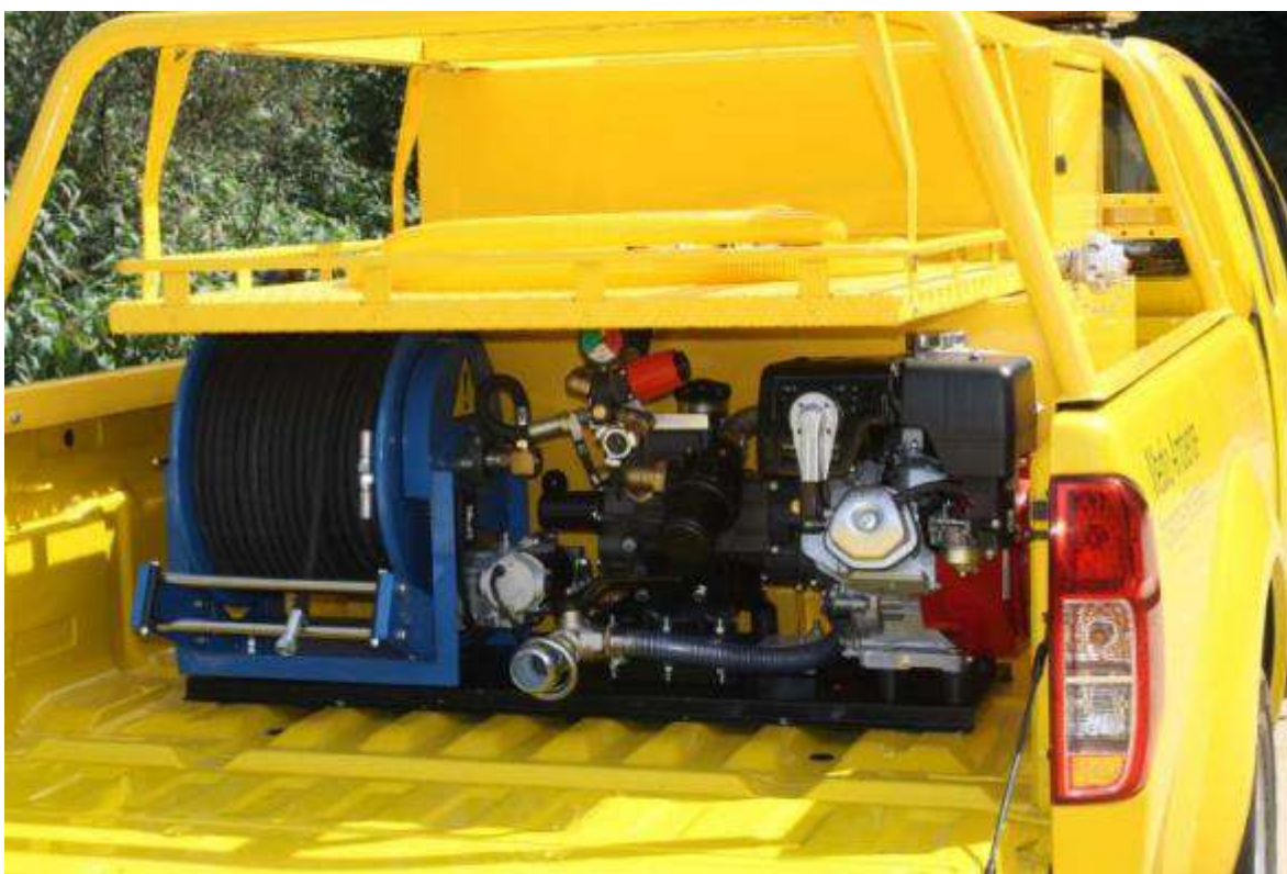
Imagen 94. Vehículo ligero equipado para incendios de IUF. Este tipo de medio terrestre resulta especialmente útil cuando se producen lluvias intensas de pavesas que afectan a la zona interior del núcleo dado que permite una defensa móvil. Además, se puede acometer tendido para recargar desde piscinas u otros reservorios dispersos en el mismo núcleo a defender. Fuente: Vallfirest
