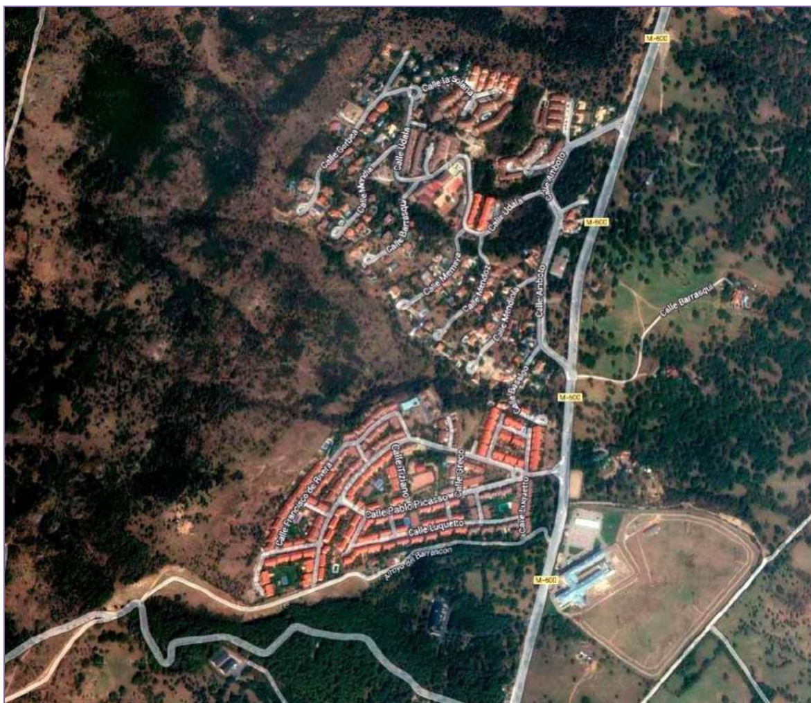
Imagen 77. Ejemplo de dos modelos diferentes de red viaria de comunicaciones. Uno permite más de una ruta y mejor circulación. El otro tiene un vial principal que si se ve comprometido condiciona toda la movilidad interior del núcleo. Fuente: Google Maps.
