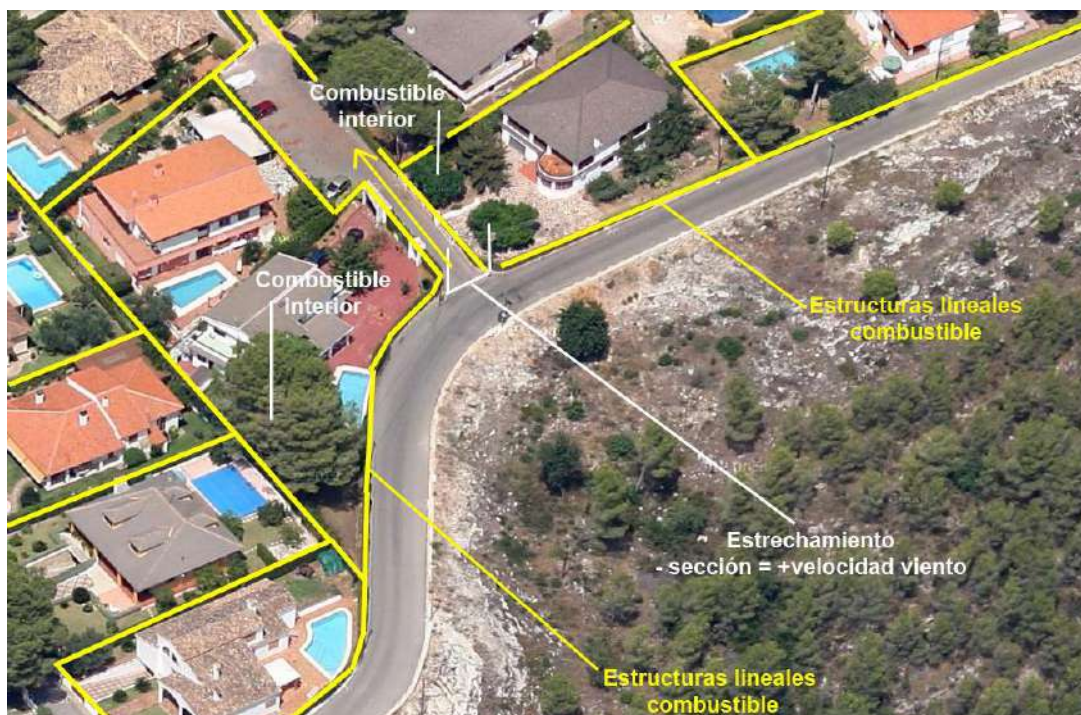
Imagen 53. Las calles o viales (estrechamientos) del propio núcleo pueden constituir corredores de fuego en los que además puede producirse una aceleración (similar a un efecto chimenea a pequeña escala) por el estrechamiento de la sección que supone aumento de velocidad ( S \times V = S' \times V' ).
