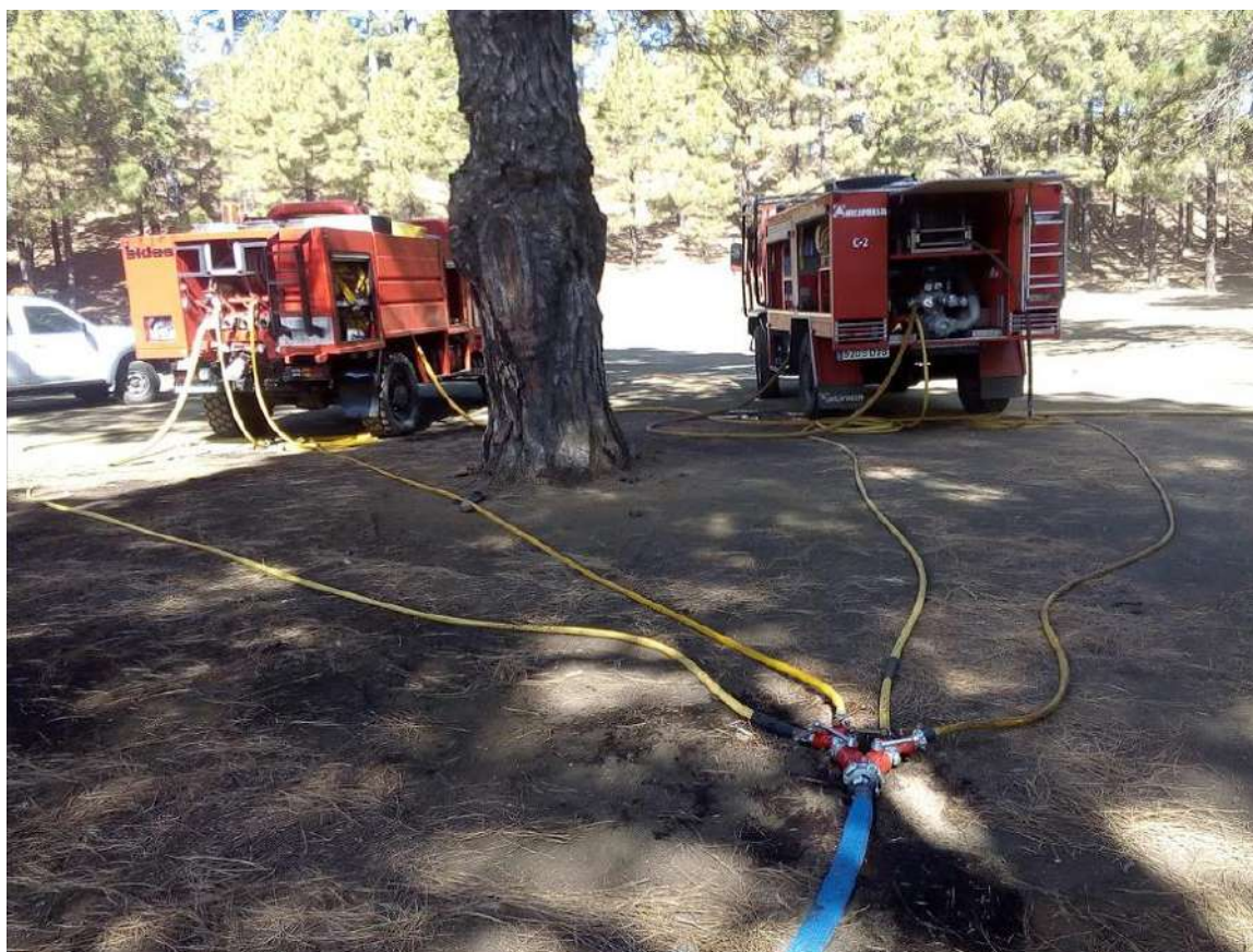
Imagen 93. Construcción de tendido de largo alcance para defensa de zona de IUF con autobombas dispuestas en paralelo. Utilización de mangueras más resistentes en el tramo central (azul) para trabajar con seguridad en alta presión combinada. Fuente: Dalmau Rovira, F.
