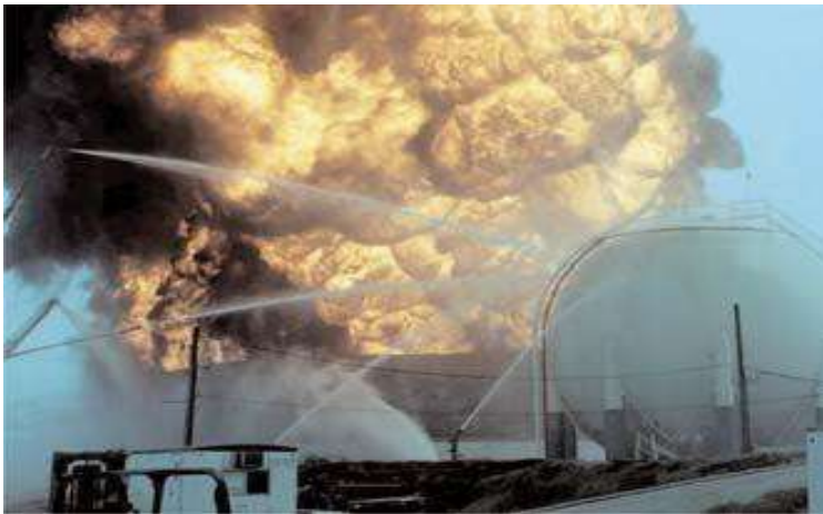
Refrigeración esfera GLP cercana a tanque incendiado
