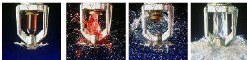
Figura 34.- Fases de la apertura de un rociador de ampolla
