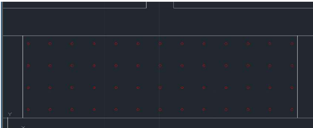
Figura 67.- Detalle distribución rociadores RO3
