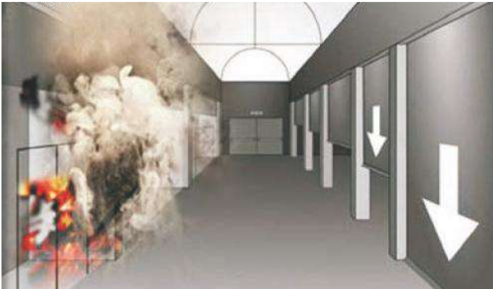
Figura 21.- Barrera de humo móvil
