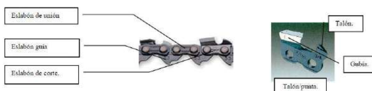
Eslabones de la cadena de la motosierra. (Fuente: J. Mozos).
