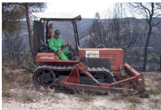
Ardilla en el incendio de Xátiva de 2005 para cierre de perímetros. (Fuente. Raúl Quílez).
