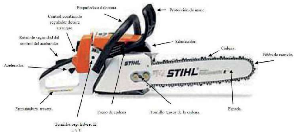
Elementos de la motosierra. (Fuente. J. Mozos).
