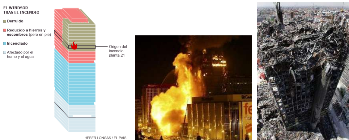
Fig. 20 Esquema de desarrollo del incendio del Windsor. - http://goo.gl/oUvVbw
