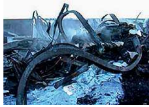
Deformación por pandeo de un pilar.
