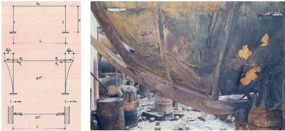
Variación de la longitud con la dilatación térmica.
