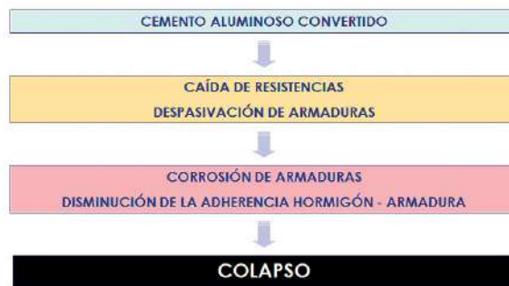
Esquema de degradación del cemento aluminoso.
