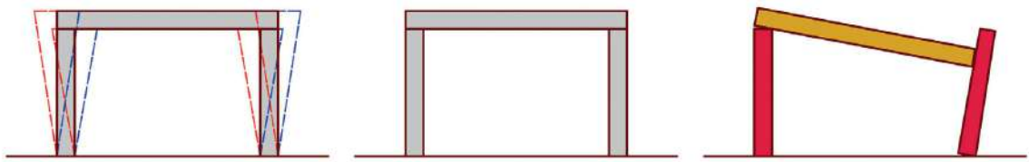
Desconexión muro-forjado por efecto del sismo.
