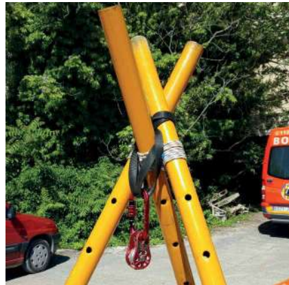
Cabecera trípode. Atado puntales. Colocación polea. (Grupo U.R.E.C., 2017, s.p.)
