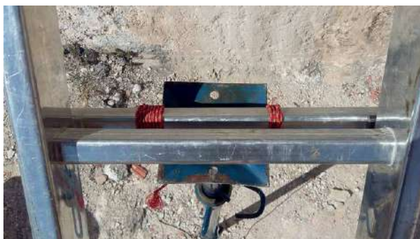
Detalle fijación puntal. (Grupo U.R.E.C., 2017, s.p.)
