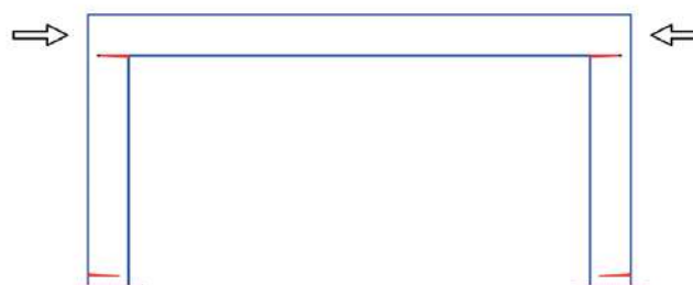
Fisuras de retracción en pórticos.
