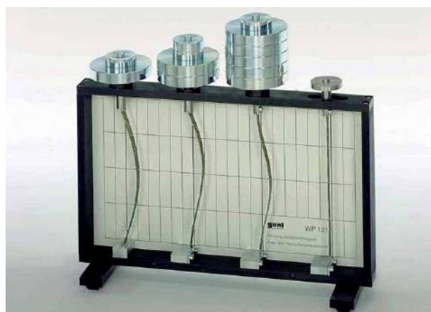
Ensayo de experimento de pandeo. (Fuente: GUNT Hamburg).
