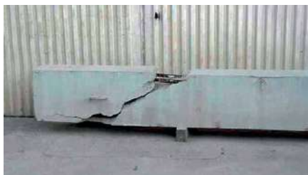
Fisuras de cortante: a) por tracción diagonal, b) por compresión diagonal.
