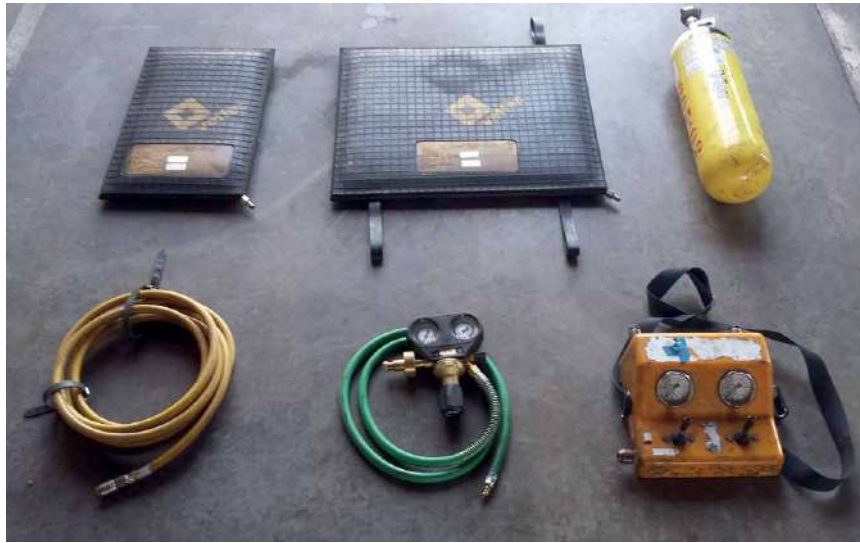
Cojines neumáticos de alta presión. (Grupo U.R.E.C., 2015, s.p.)
