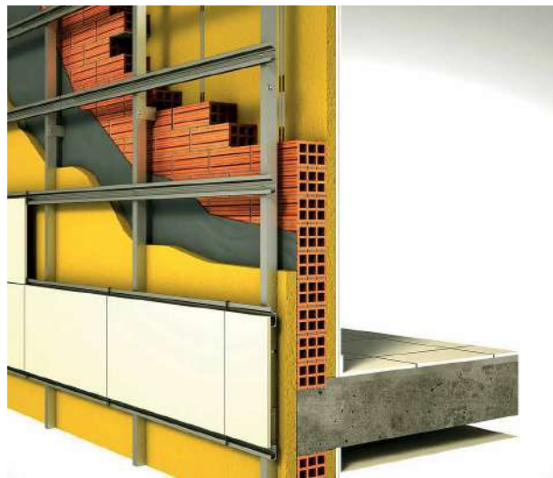
Fachada ventilada. (Fuente. Intec).
