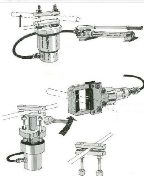
Figura 25: Anulación de una tubería con un estrangulador hidráulico
