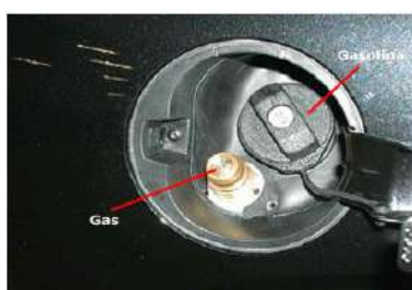
Boca de llenado dos entradas
