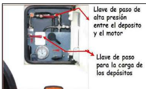
Válvula de corte geenal autobus MAN ubicado entre la puerta de entrada de pasajeros y el arco de rueda del. derecha
