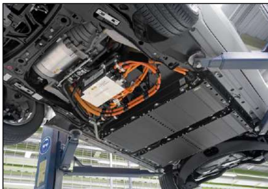
Batería en los bajos y cables naranja
