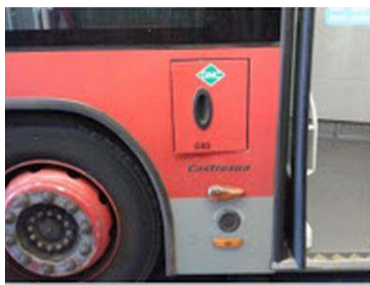
Trampilla de carga y válvula general de corte
