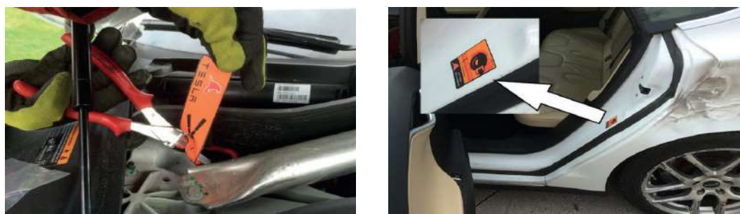
Anillo de aislamiento en algunos modelos de Tesla.
