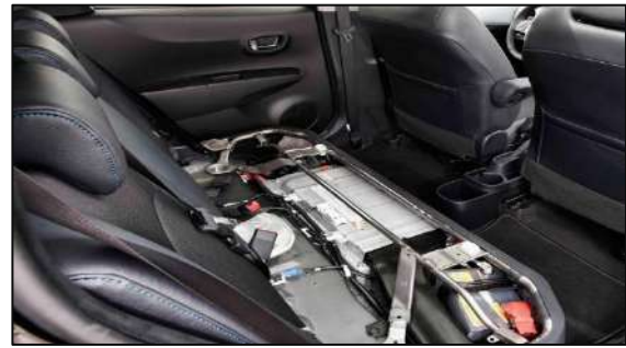
Batería bajo banqueta trasera
