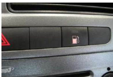
Detalle selector gasolina apagado, GNC activado en el display
