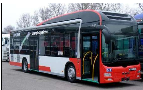
Techo abultado (baterías de AT)
