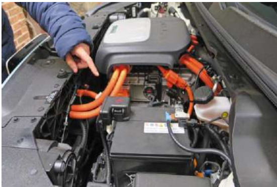
Inversor ubicado en el bloque motor
