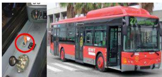
Interruptor seguridad ubicado en el panel de mandos
