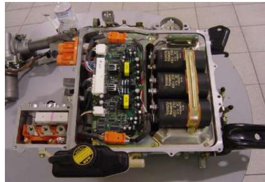
Detalle condensadores del inversor
