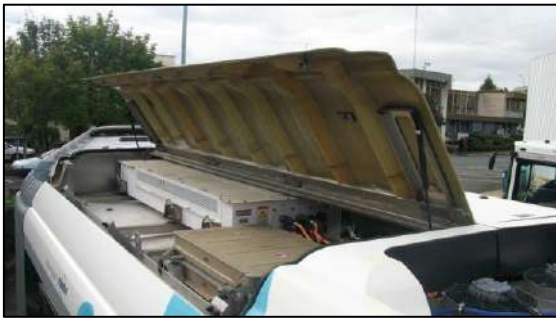
Batería en el techo de autobús
