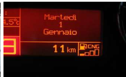
Detalle selector gasolina apagado, GNC activado en el display
