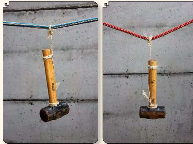
FOTOGRAFÍA 2. CUERDA ESTÁTICA. Este tipo de cuerda tiene poca elasticidad y elongación.
