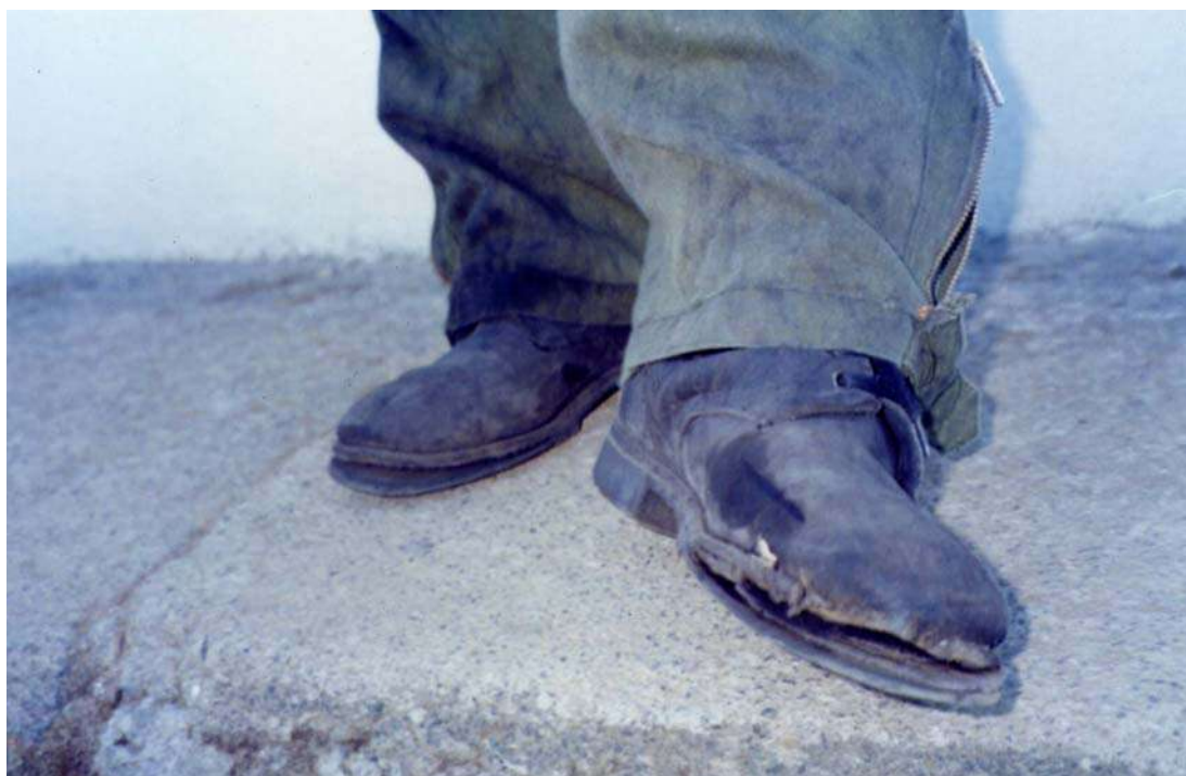
Foto 3: Efecto de las altas temperaturas del suelo sobre las botas
