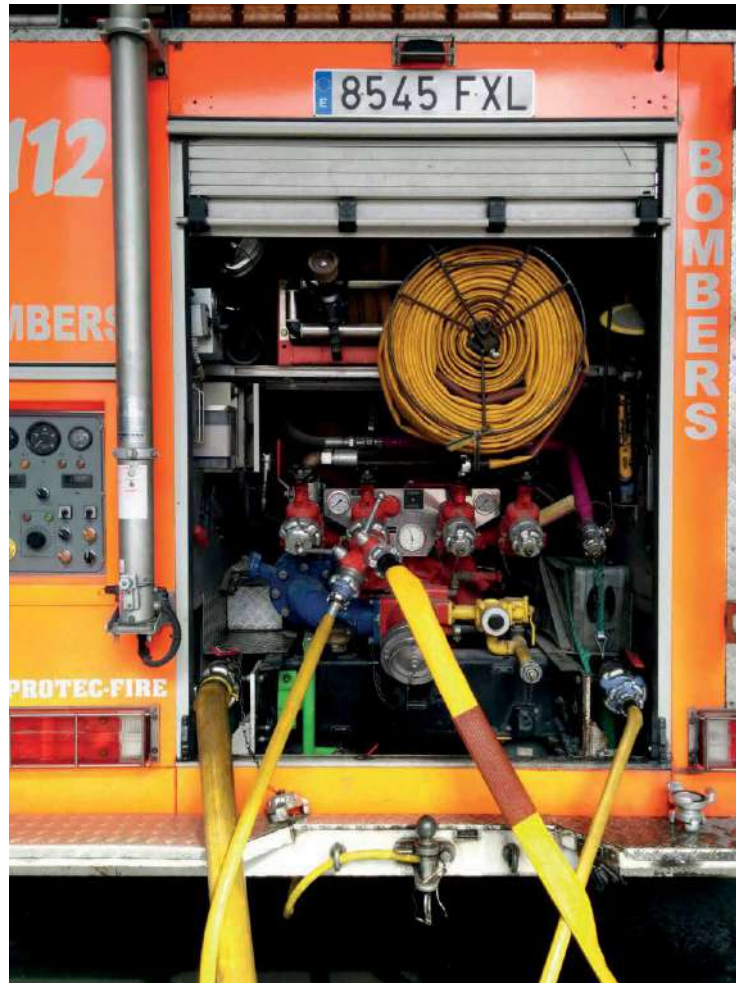
Vista bomba con instalación de recirculación.
