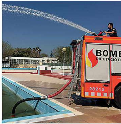
Aspiración e impulsión por monitor.
