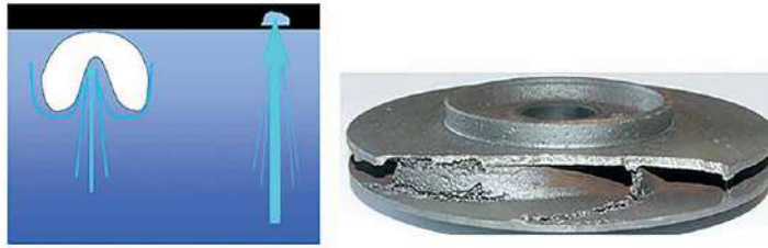
Detalles de la erosión en la superficie de los álabes del rodete.
