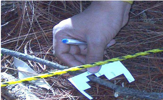
Figura 17. Contabilizando material combustible de 1 hora.
