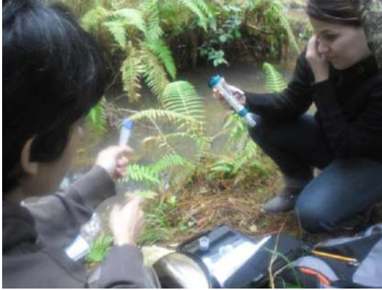
Figura 39. Toma de muestra en cuerpos de agua para determinar el pH.
