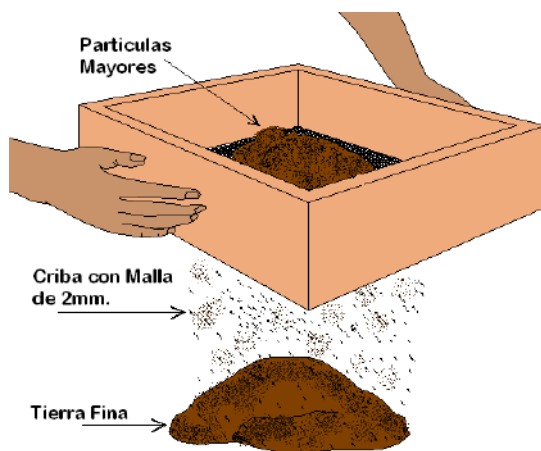
Figura 37. Proceso de tamizado de una muestra de suelo.
