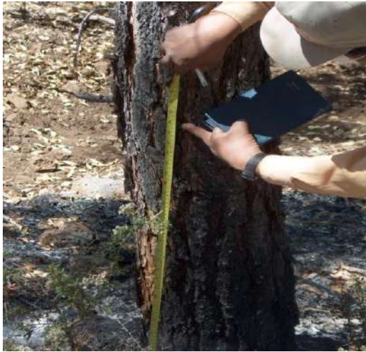
Figura 34. Medición de la altura estimada de llama con base al chamuscado (quemado) de la corteza de los árboles.
