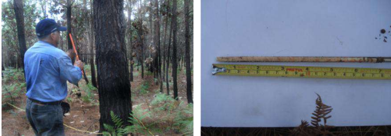
Figura 28. a) Uso del taladro de Pressler a una altura de 1.30 m, para sacar una muestra (viruta) (b), la cual permite determinar la edad del árbol.
