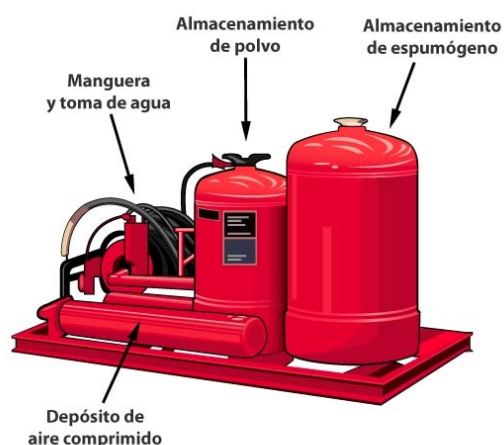
Figura 3. Almacenamiento de espuma anti-incendios
