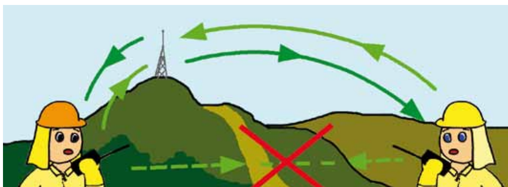
Figura 96. Funcionamiento canal en semidúplex
