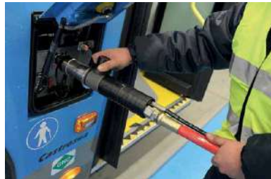
Boca de llenado GNC en un autobús.
