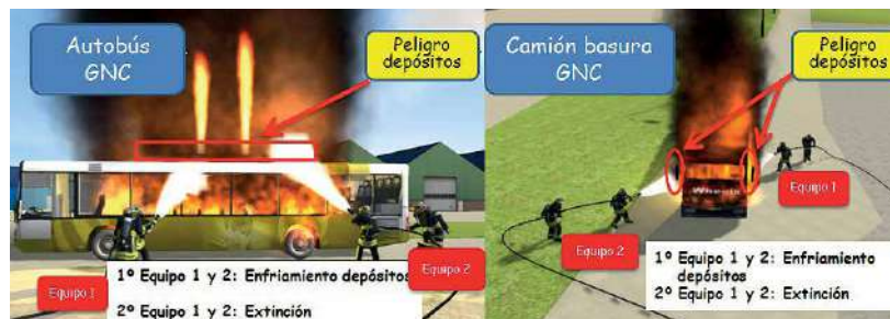
Ejemplo: Incendio en vehículos pesados a gas.
