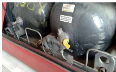
Depósitos GNC en el techo de un autobús.
