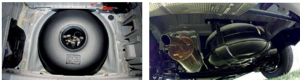
Diferente ubicación del depósito toroidal GLP en un turismo
