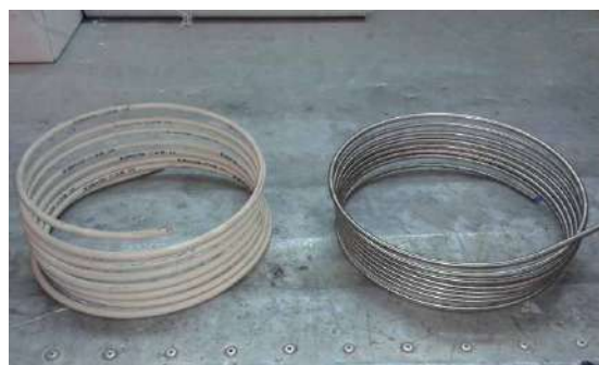
Tuberías de acero para gas natural.
