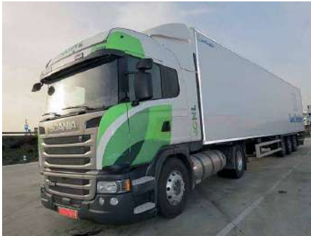
Scania G340 Streamline con dos depósitos de GNL.
