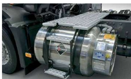
Depósito GNL en un camión Dual-Fuel.
