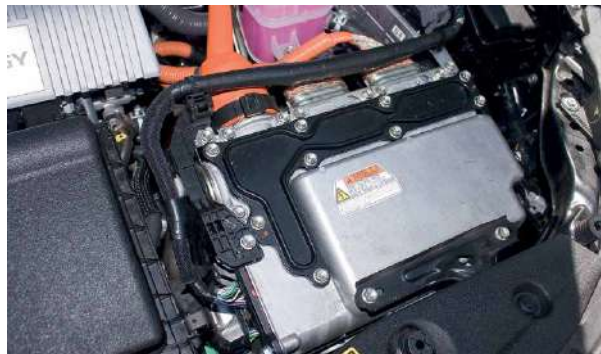
Cableado naranja conectado al inversor/convertidor.
