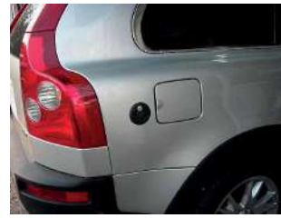
Boca de llenado GLP separada.
