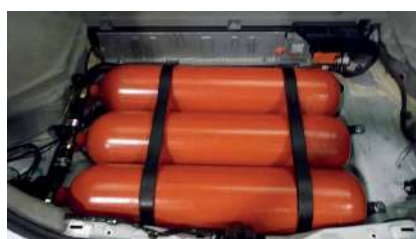
Depósitos en un Toyota Prius híbrido convertido a GNC.
