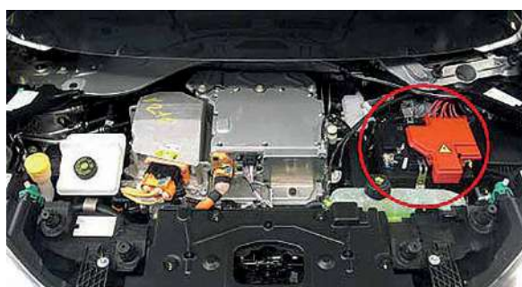
Batería auxiliar Renault ZOE eléctrico
