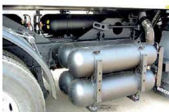
Depósitos GNC en un camión.
