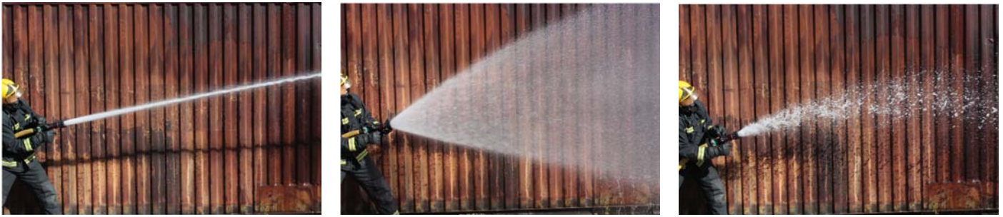
Imagen 44. Secuencia comparativa del tamaño de gota por una lanza de bomberos. La mayor evaporación se va a conseguir con una gota fina propia de un cono de niebla. Chorro sólido o conos de gota gruesa tienen menor eficiencia.
