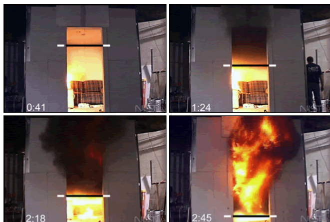
Imagen 21. Evolución de un incendio. Las dos imágenes superiores corresponden a un Incendio Limitado por el Combustible (ILC). En la última imagen (2:45) se aprecia claramente un Incendio Limitado por la Ventilación (ILV).
