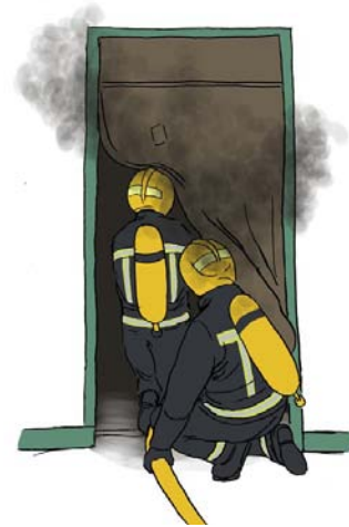
Imagen 105. Empleo de cortina de bloqueo de humo en el acceso a un incendio
