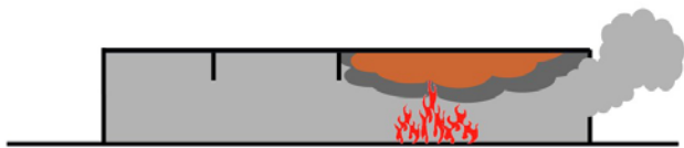
Imagen 6. El incendio de interior se desarrolla en un espacio cerrado que puede tener aperturas al exterior.
