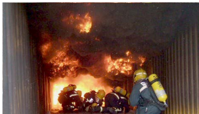
Imagen 14. Flashover en una práctica de formación en un contenedor metálico.
