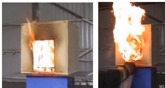
Imagen 74. Clásico ejercicio en "casa de muñecas". La aplicación del spray de agua al interior desplaza los gases de incendio al exterior que se inflaman al contacto con el aire.
