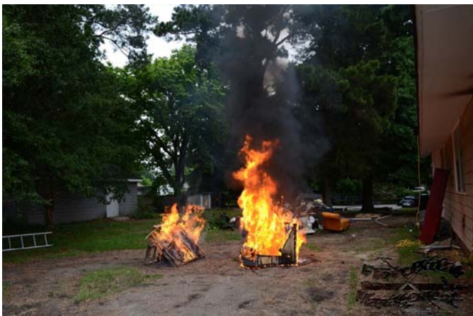
Imagen 32. Comparación de los combustibles modernos ricos en materiales sintéticos y derivados del petróleo con los combustibles tradicionales (madera maciza, fibras textiles vegetales).
