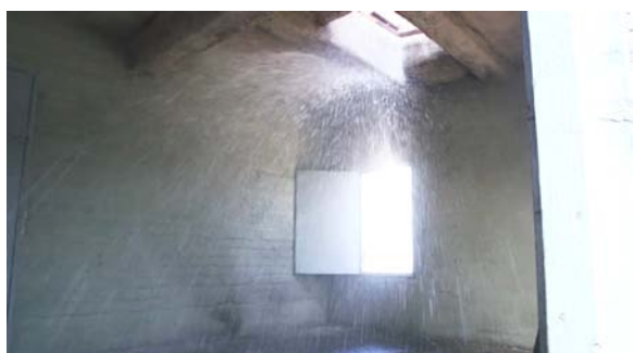
Imagen 92. Vista del interior con el chorro rompiendo en el techo en gotas mas pequeñas.
