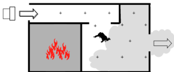
Imagen 119. Esquema en planta de una ventilación en presión positiva defensiva. El flujo creado por el ventilador no atraviesa el foco de incendio.
