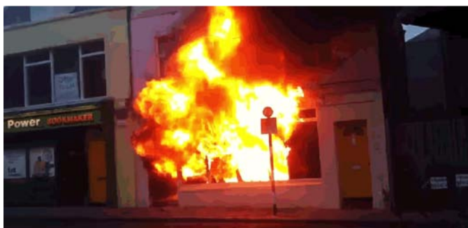
Imagen 30. Incendio en Dalkey Road (Dublín). En la imagen superior se aprecia un incendio infraventilado. A pesar de que la puerta está abierta, el flujo de aire es insuficiente y el incendio no llega a transcurrir por una etapa de flashover . La imagen central reproduce el momento en el que los cristales del escaparate se rompen. Abajo la imagen 1 minuto después en plena etapa de flashover inducido por la ventilación.
