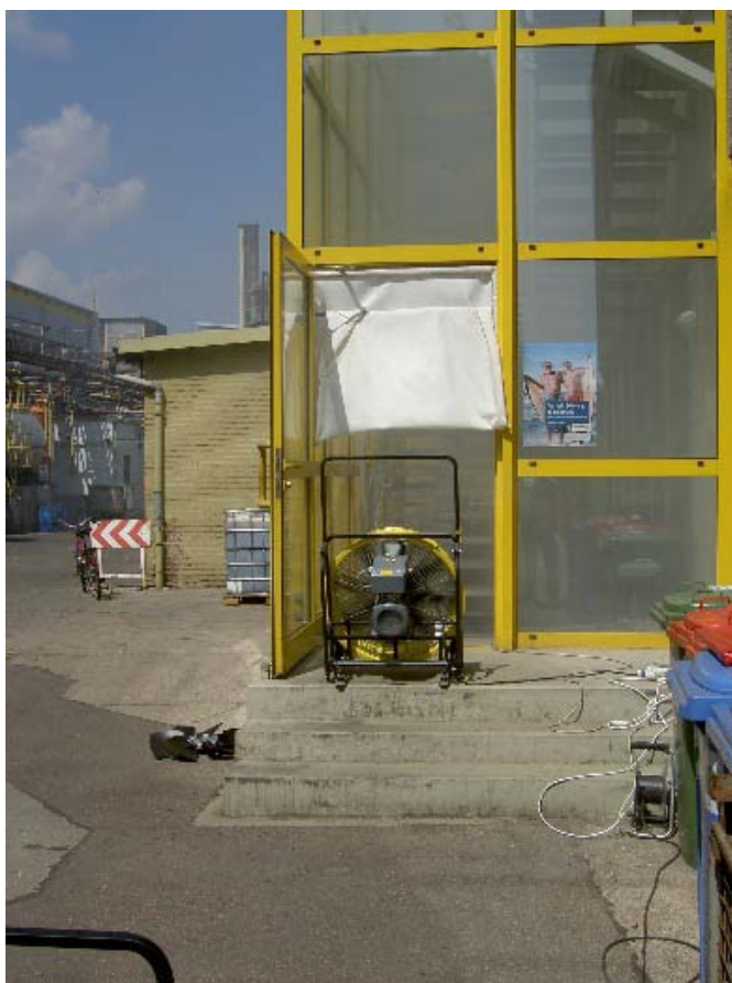
Imagen 139. Cortina de bloque de humo recogida hasta media altura para reducir el tamaño de la apertura de entrada y conseguir una mayor presurización. En este test se consiguió aumentar la presión desde los 30Pa de media con la apertura completa a 60Pa con la apertura al 50%.
