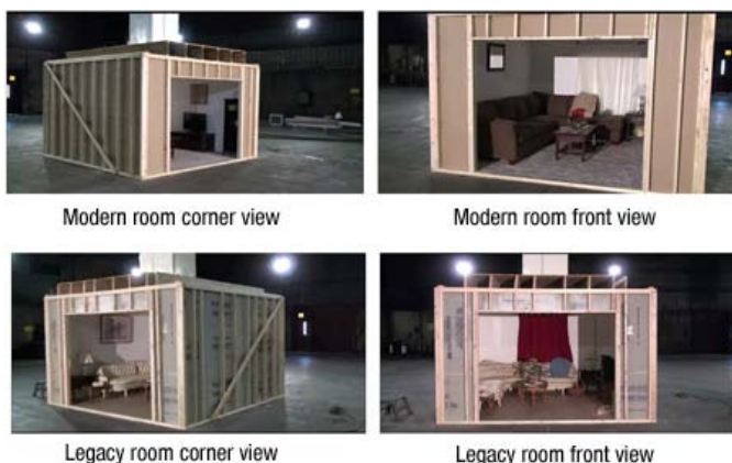
Imagen 5. Detalle de la configuración del experimento de comparación de combustible moderno y tradicional.
