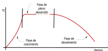
Imagen 8. Curva de evolución de la temperatura mostrando las fases de desarrollo de un incendio de interior.
