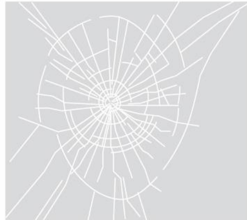
Vidrio Laminado Quebrado.
