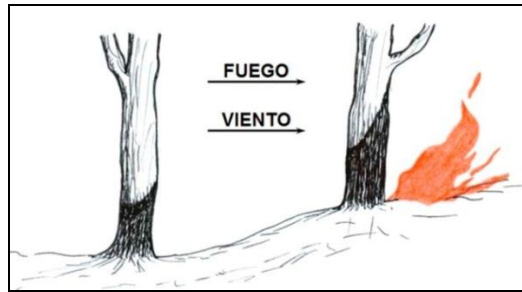
Figura 19. Modelo de carbonización, fuego avanzando con pendiente y viento a favor.
