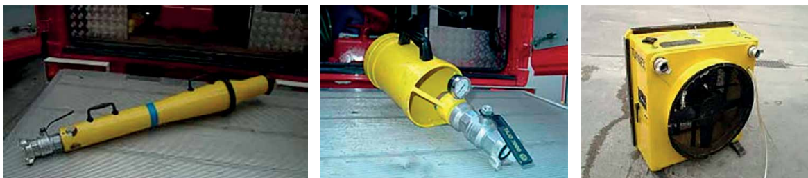
Lanzas de baja y media expansión (izquierda y centro) y generador de alta expansión (derecha)
