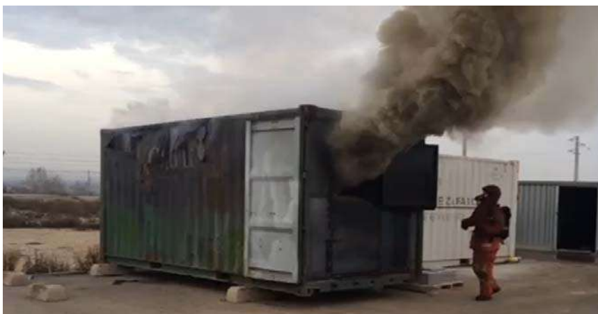
Figura 41. Simulación real de Backdraft en un incendio en recinto confinado. (Fuente: Consorcio Provincial de Bomberos)
