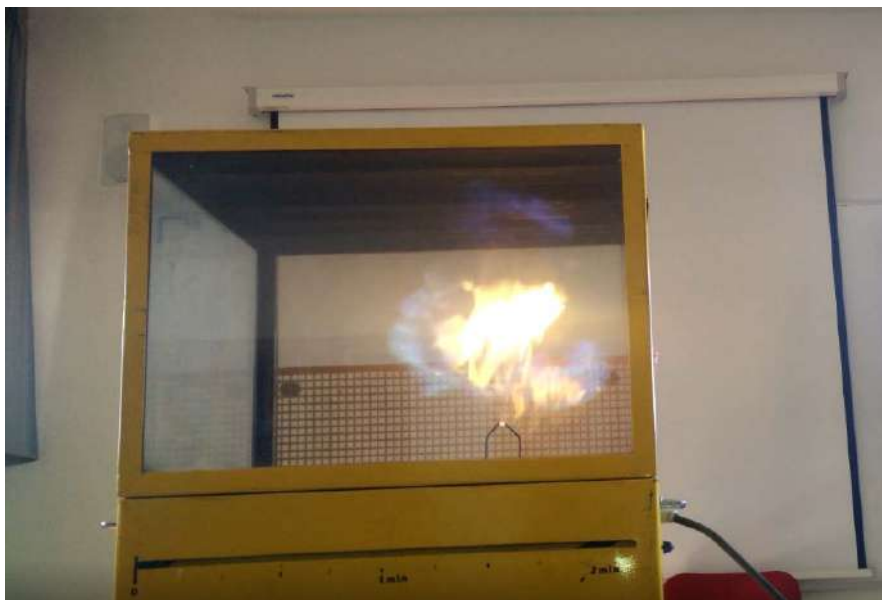
Figura 22. Imagen de la cámara de vídeo en el experimento 4, momento de la deflagración. (Fuente: propia)
