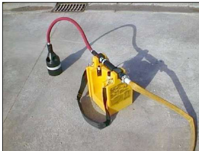
Premezclador y depósito en punta de lanza
