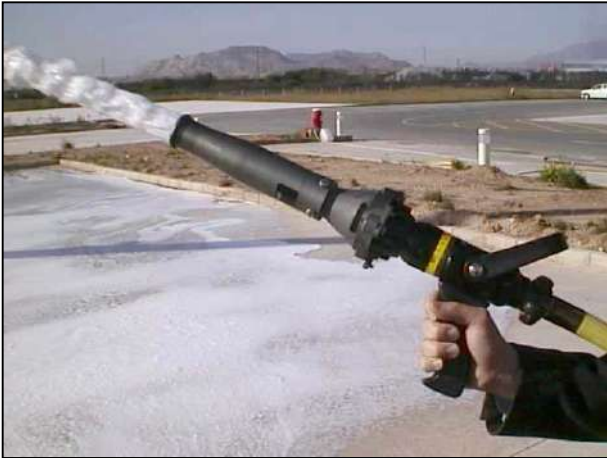
Lanza convencional con expensor de espuma de baja
