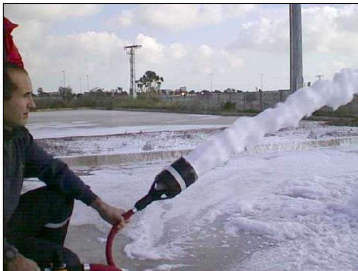
Generador de espuma de media expansión
