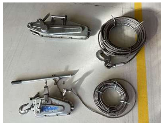
▲ Tráctel / Polipastos con cables de distintas longitudes y diámetros. Pasador de Seguridad Gancho de Carga, traccionar y elevar.
