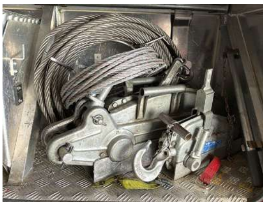
▲ Tráctel / Polipastos con cables de distintas longitudes y diámetros. Pasador de Seguridad Gancho de Carga, traccionar y elevar.
