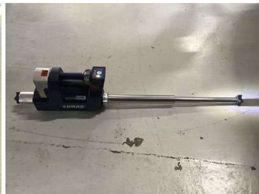
▲ Cilindro eléctrico/batería (también puede ser hidráulico): usado para crear y agrandar espacios especialmente en accidentes de tráfico en los vehículos, pero no exclusivamente.
